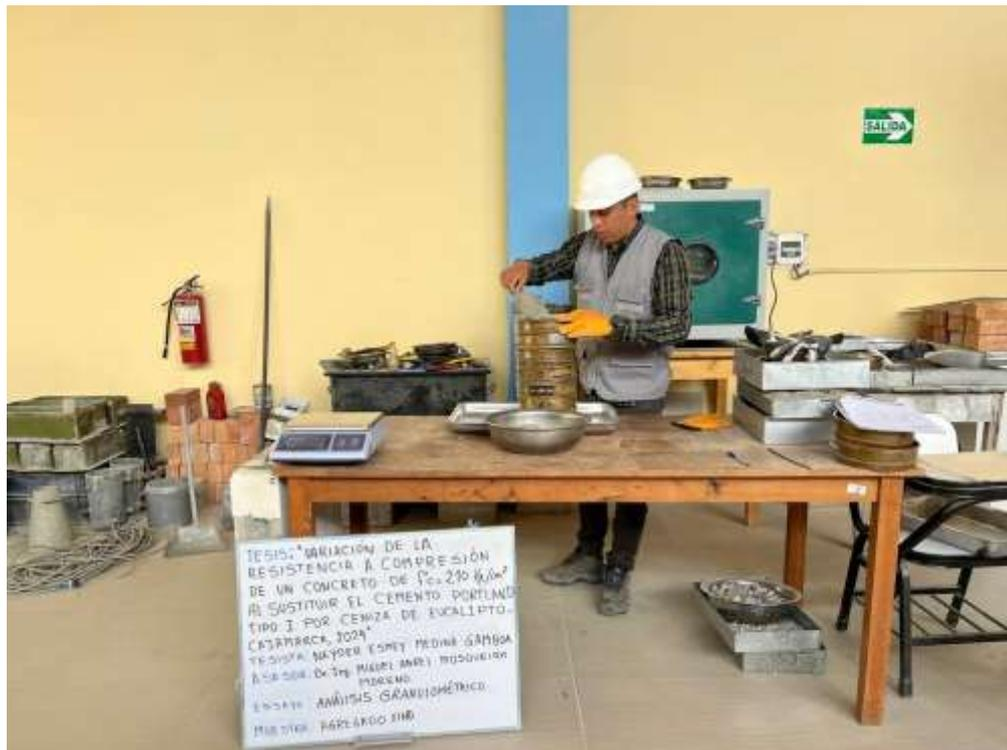
**Figura 18.** Tamizado de la ceniza de eucalipto para eliminar las impurezas.
