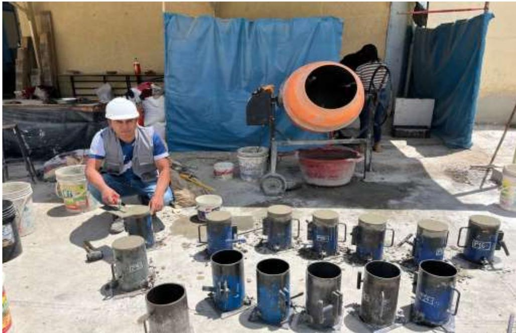
**Figura 22.** Verificación del Slump de muestra patrón
