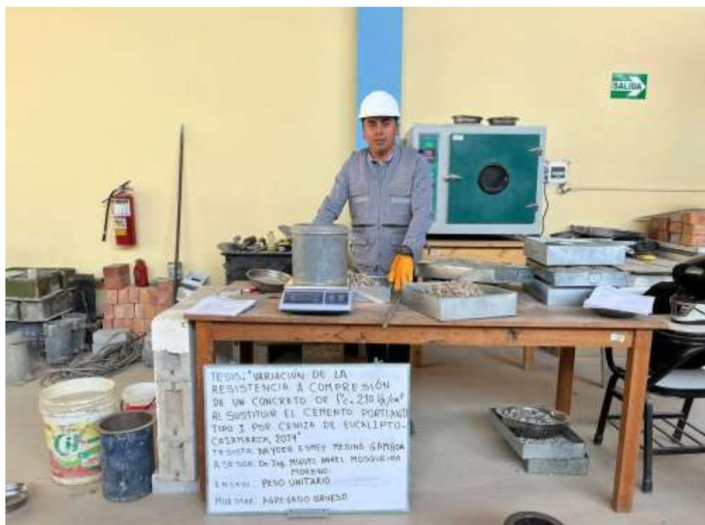
**Figura 15.**Ensayo para determinar el peso específico del agregado fino.
