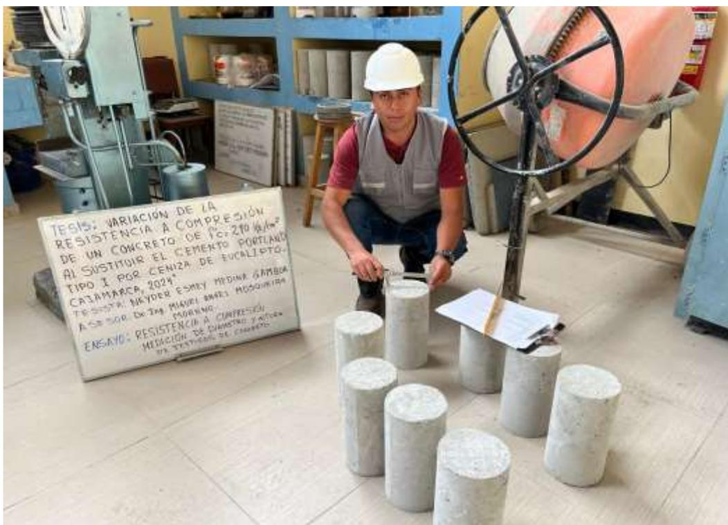
**Figura 25.** Ensayo a la compresion de probetas cilindricas a los 14 días de curado
