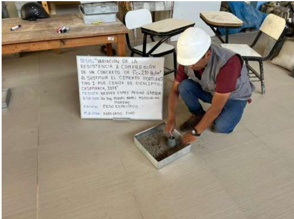
**Figura 16.**Ensayo para determinar el peso específico agregado grueso.
