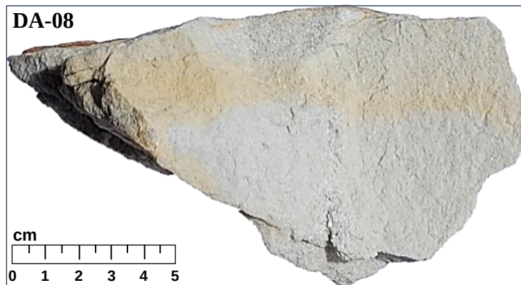
Foto 21. Muestra de arenisca DA-08 para pruebas de densidad, observándose dominio de cuarzo.
