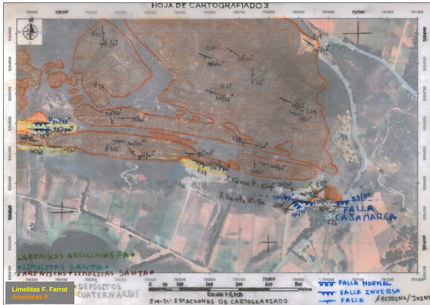
Figura 17. Cartografiado realizado en Hoja Canson A4 transparente a escala 1:5000, donde se aprecian todas las estaciones mencionadas en la Hoja de Cartografiado 3, se puede apreciar que se usó imagen satelital como mapa base.
