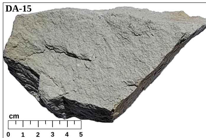
Foto 37. Muestra DA-15 para pruebas de densidad por método de parafina.
