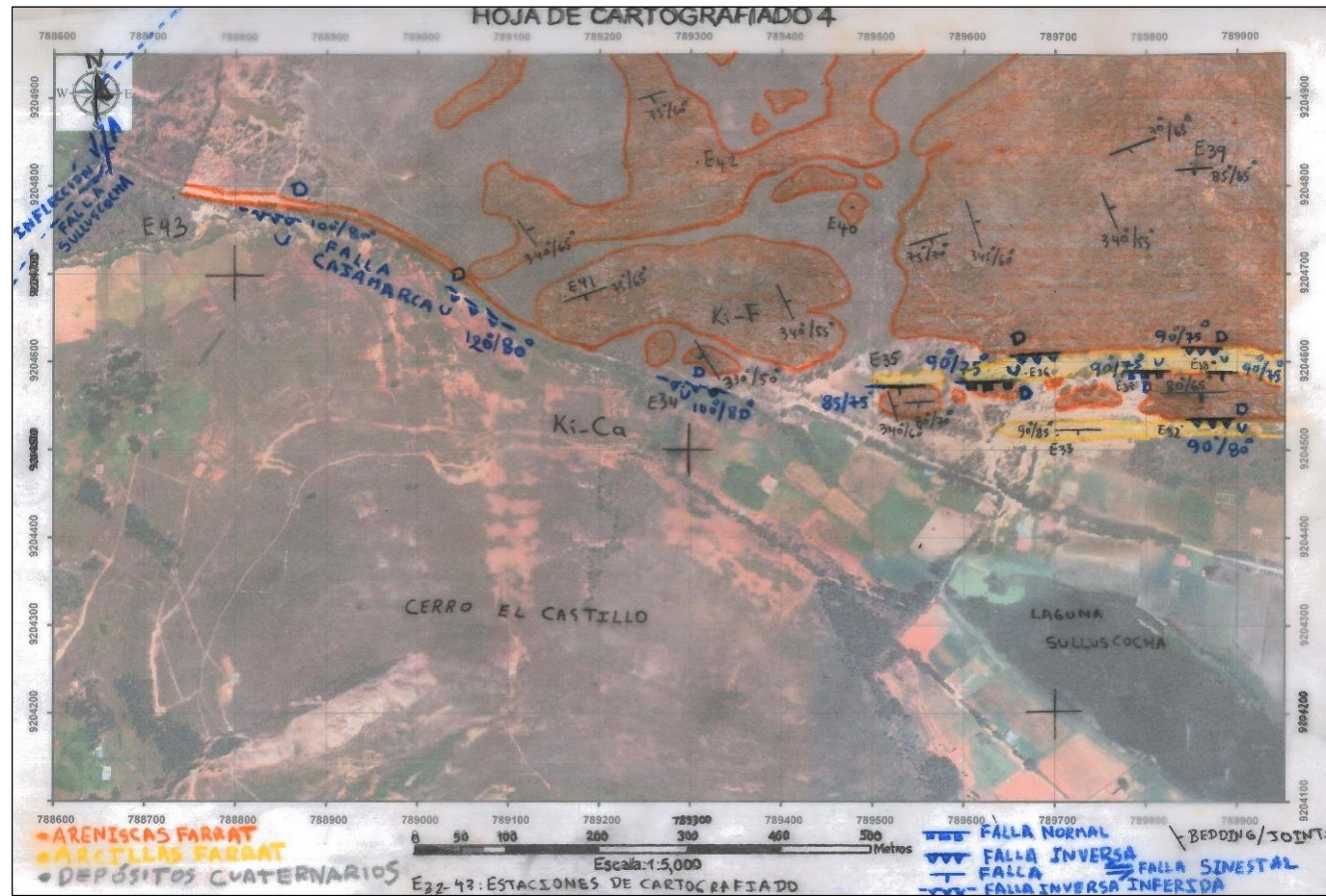
Figura 19. Cartografiado realizado en Hoja Canson A4 transparente a escala 1:5000, donde se aprecian todas las estaciones mencionadas en la Hoja de Cartografiado 4, se puede apreciar que se usó imagen satelital como mapa base.
