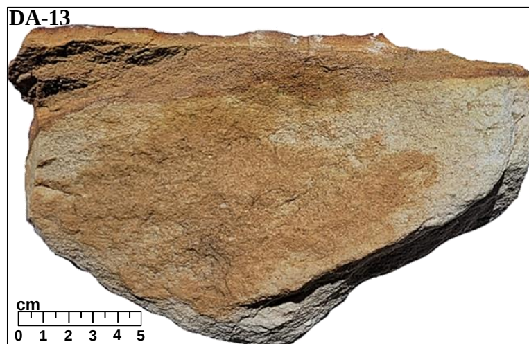
Foto 32. Muestra de arenisca DA-13 para pruebas de densidad por método de parafina, obsérvese incremento en el % de óxidos de hierro.
