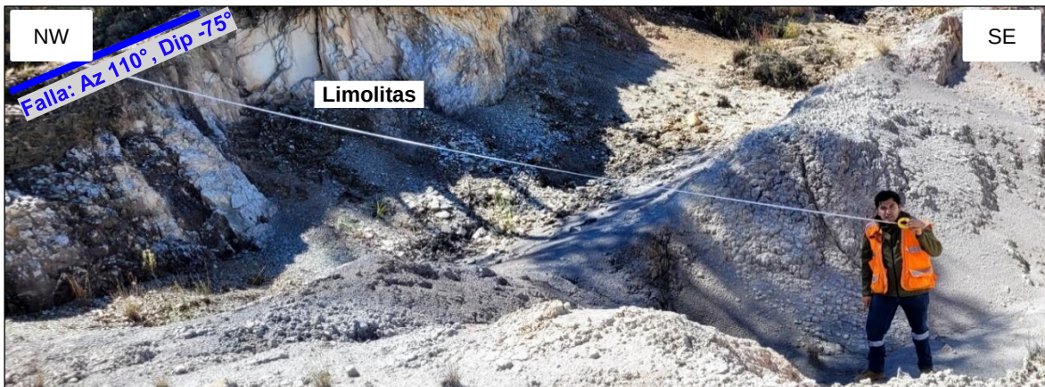
Foto 95. Tesista realizando medición de potencia en Estación 29 de afloramiento de limolitas, de acuerdo a las características mineralógicas de dureza, color, raya y textura a la lupa, se identificaron caolín, illita y montmorillonita, con las siguientes coordenadas: Norte: 9204446.87, Este: 790577.69, Elevación: 3017.52.
