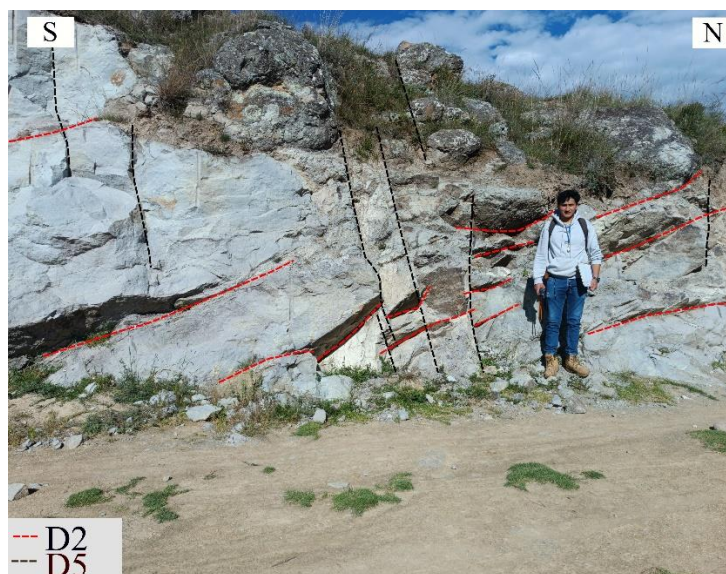
Figura 75. Fracturas en la rocas subvolcánicas, N: 9212590, E: 772406, Cota: 2918 m.s.n.m.
