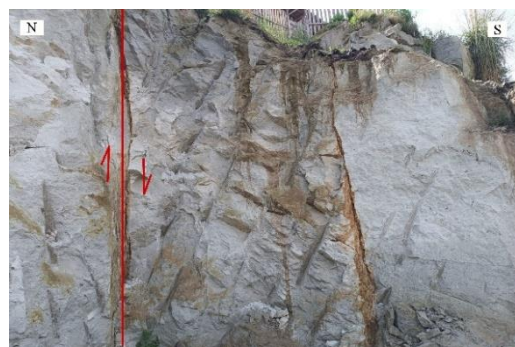
Fotografía 45. Falla normal en tobas N: 921257 E: 774899 Cota: 2768 m.s.n.m.
