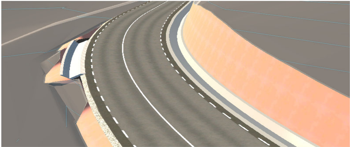
Figura N° 48: Tramo de cuneta innecesaria
