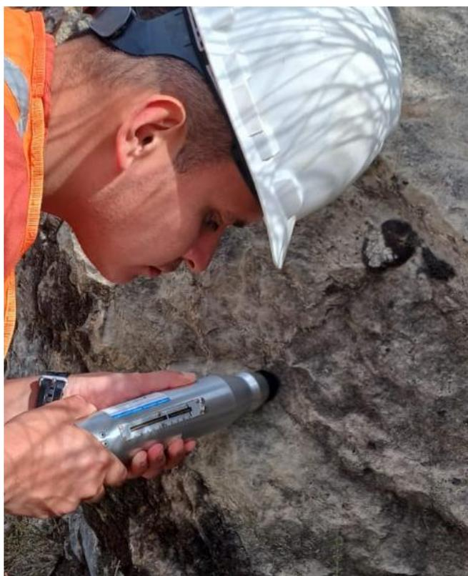
Figura 4.3. Martillo de Schmidt CONTROLS, tipo L, Modelo 45- 561.
