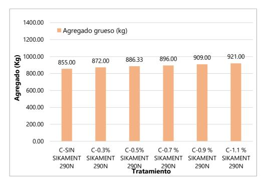
En la figura de agregado grueso, se observa un aumento progresivo en la cantidad de agregado grueso conforme se incrementa la dosificación del aditivo:
