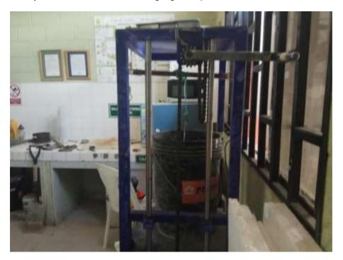
**Fotografía 5.**Especímenes de concreto luego de realizar las pruebas de penetración para determinar el tiempo de fragua.
