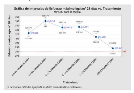
La gráfica de intervalos muestra el intervalo de confianza para cada tratamiento y el valor de la media de resistencia a la compresión. Para el tratamiento C-0.3% SIKAMENT 290N, se observó una media de 322.80 kg/cm². De manera similar,
