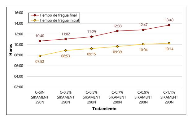
Tratamiento sin Sikament (C-SIN SIKAMENT 290N): El tratamiento de control presentó los tiempos de fragua más cortos, con una fragua inicial de 472.29 minutos (7 horas y 52 minutos) y una fragua final de 640.98 minutos (10 horas y 40 minutos). Esto indica que el concreto sin aditivo tiene una reacción más rápida en comparación con los tratamientos con Sikament, lo que puede limitar el tiempo disponible para su manipulación.
