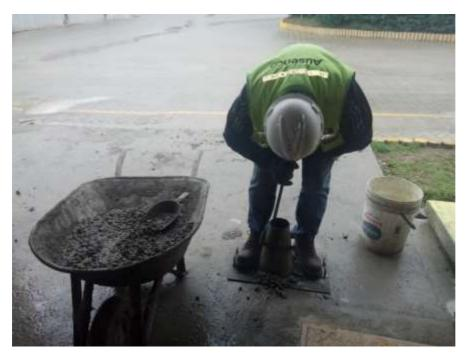
**Fotografía 2.**Tesista realizando el ensayo de Asentamiento para verificación de Especificación de diseño.
