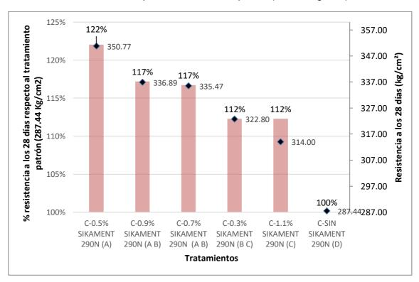
El Gráfico 18 muestra el comportamiento de la resistencia a compresión de los especímenes cilíndricos de concreto a los 28 días, tomando como base el porcentaje de resistencia alcanzada en comparación con el tratamiento patrón (concreto sin aditivo, C-SIN SIKAMENT 290N, 287.44 kg/cm²). El análisis revela que los tratamientos con adiciones de Sikament 290N presentan variaciones significativas en la resistencia a compresión, dependiendo de la dosis utilizada.
