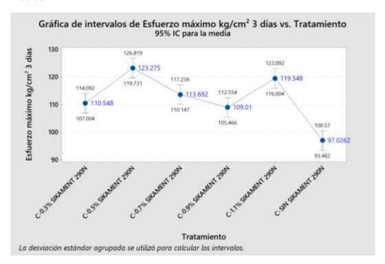
La gráfica de intervalos muestra el intervalo de confianza para cada tratamiento y el valor promedio de la resistencia a la compresión alcanzada. Por ejemplo, el tratamiento con C-0.3% Sikament 290N tiene una resistencia media de 110.55 kg/cm², con su intervalo de confianza entre 107.00 y 114.09 kg/cm².
