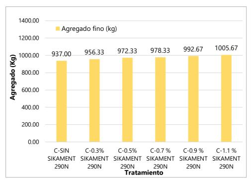
La figura correspondiente al **agregado fino** sigue una tendencia similar. A medida que aumenta la dosificación del aditivo, también aumenta la cantidad de agregado fino en la mezcla.
