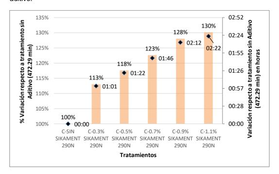
La Figura 19 muestra la variación en el tiempo de fragua inicial para los diferentes tratamientos con Sikament 290N en comparación con el concreto sin aditivo. El tratamiento sin aditivo tiene un tiempo de fragua inicial de 472.29 minutos (7 horas y 52 minutos), que se toma como base (100%) para las comparaciones.
