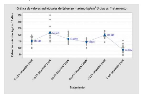
La Figura 8 muestra la gráfica de valores individuales del esfuerzo máximo de compresión en kg/cm² a los 3 días para cada tratamiento con adición de
