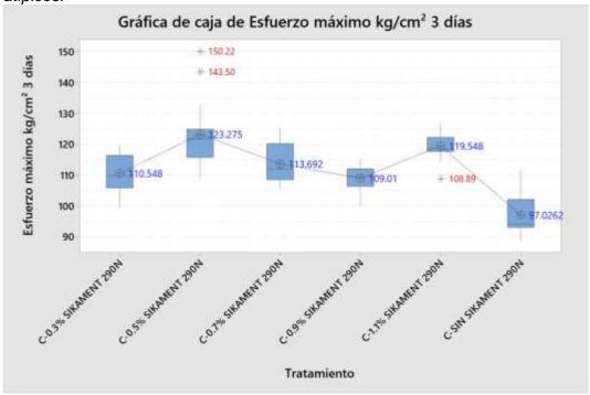
La gráfica boxplot (diagrama de caja) representa el comportamiento de cada tratamiento, indicando el desempeño y la dispersión de los datos obtenidos en las pruebas de resistencia a compresión. Cada caja muestra la distribución de los datos, desde el primer cuartil hasta el tercer cuartil, con la mediana marcada en el interior. Los puntos fuera de las cajas representan los valores atípicos.
