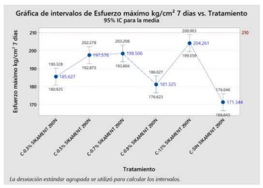
La gráfica de intervalos muestra el rango de confianza del 95% para cada tratamiento, indicando el valor de la media y su dispersión. Esto refleja cómo se posiciona cada media de resistencia a la compresión. Por ejemplo, en el tratamiento con C-0.3% SIKAMENT 290N, la resistencia media obtenida fue de 185.63 kg/cm², dentro de un intervalo de (180.92, 190.33) kg/cm². Así, se puede apreciar el comportamiento de la resistencia a compresión para los diferentes tratamientos a los 7 días.
