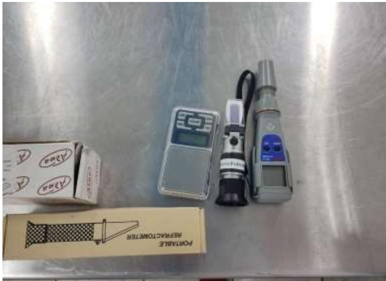
*Refractómetros para medición de sólidos solubles ( $^{\circ}$ Brix) en salsas*
