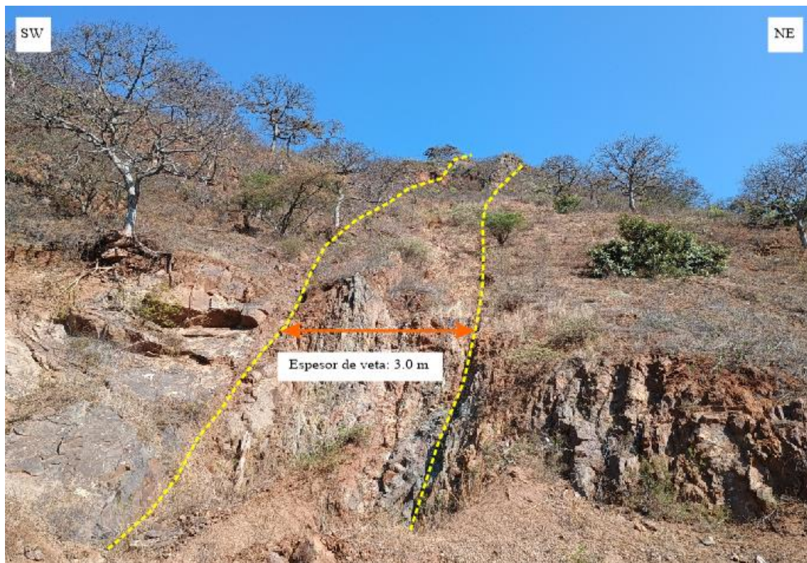
Foto 11. Estructura mineralizada, veta Victoria, potencia de 3.0 m e inclinación de 70°.
