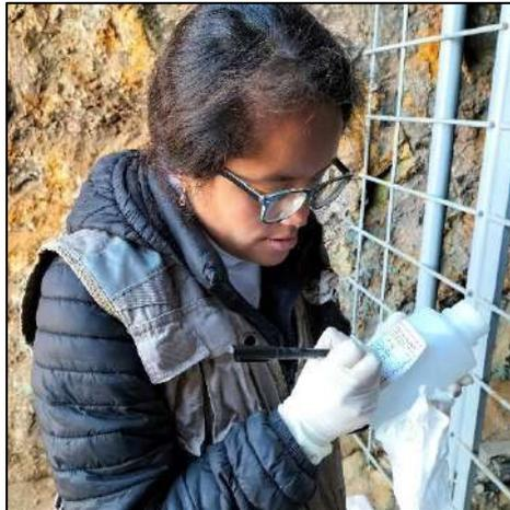
Foto 31: Sellado y etiquetado de la muestra M-02 para envío a laboratorio en época de estiaje.
