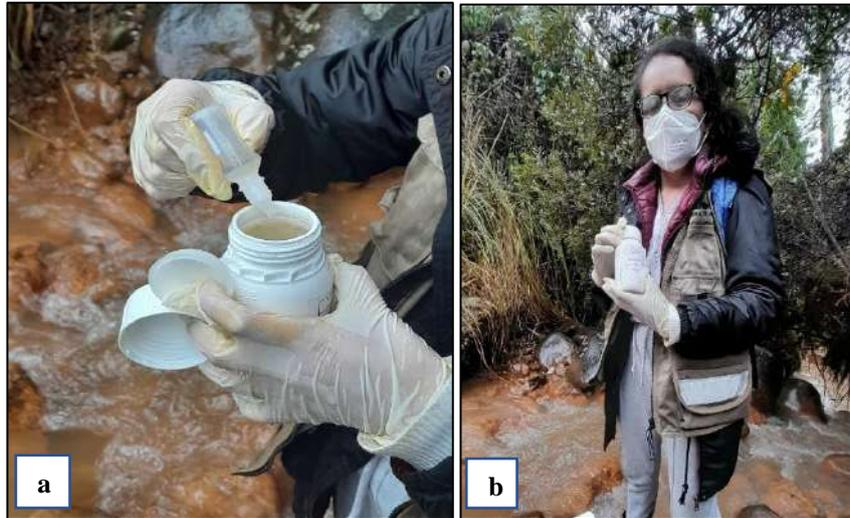
Foto 34: a. Recolección y preservación de la muestra M-03 en época de lluvia. b. Sellado y etiquetado de la muestra M-03 para envío a laboratorio en época de lluvia.
