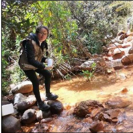
Foto 36: Etiquetado de la muestra M-03 para envío a laboratorio en época de estiaje (menor caudal del río Michiquillay).
