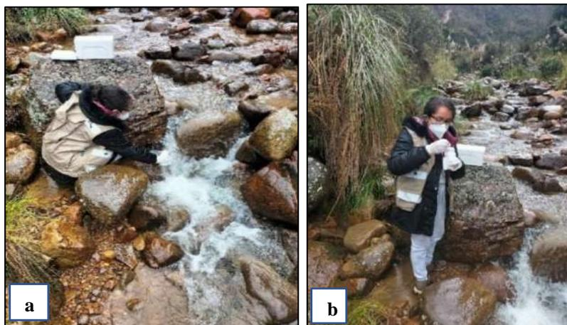
Foto 23: a. Toma de muestra M-01 en época de lluvia. b. Preservación de la muestra M-01 en época de lluvia.
