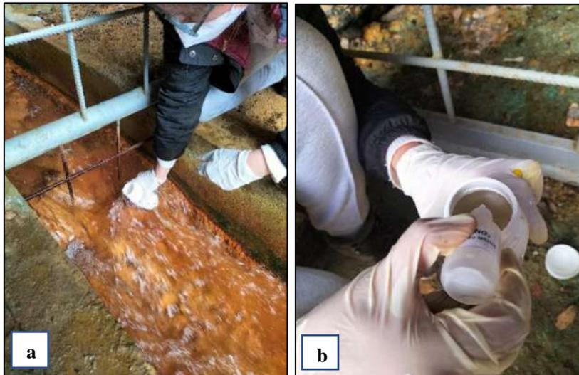
Foto 28: a. Toma de muestra M-02 en época de lluvia. b. Preservación de la muestra M-02 en época de lluvia.
