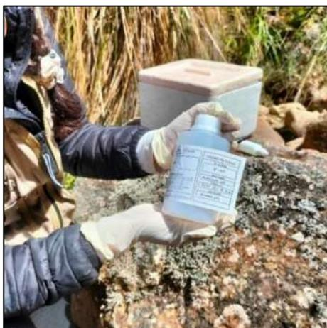
Foto 26: Sellado y etiquetado de la muestra M-01 para envío a laboratorio en época de estiaje.
