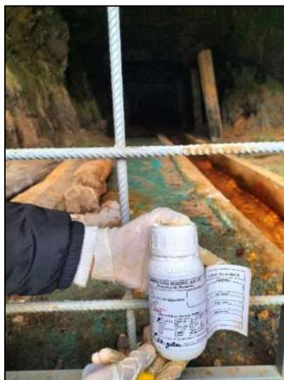
Foto 29: Sellado y etiquetado de la muestra M-02 para envío a laboratorio en época de lluvia.
