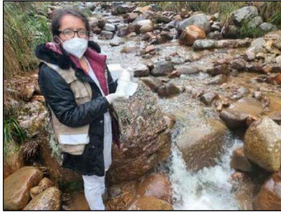
Foto 24: Sellado y etiquetado de la muestra M-01 para envío a laboratorio en época de lluvia.
