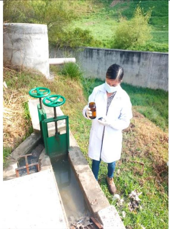
Toma de muestra del parámetro de Coliformes Termotolerantes
