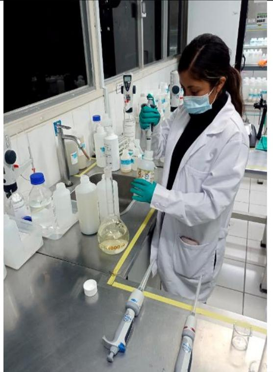
Colocación de diferentes dosis de reactivo Fenton en la muestra contaminada a las fioas en diferentes tiempos y pH.
