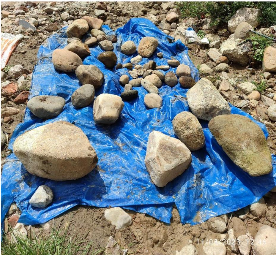
**Figura 24:** Muestreo de arenas y gravas (calicatas)
