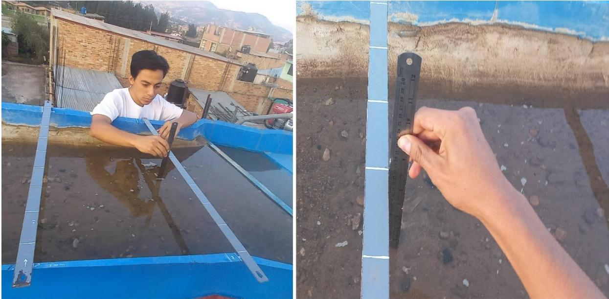
**Figura 63:** *Medición de tirantes sobre la corona del barrage*
