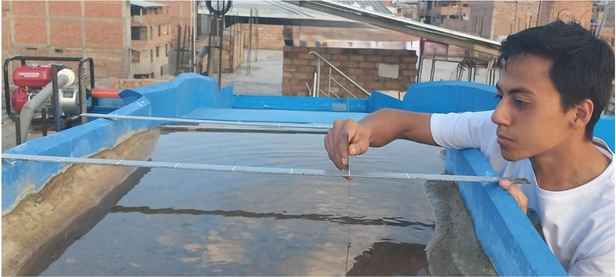
**Figura 77:** *Medición de altura de sedimentos después de la descolmatación*
