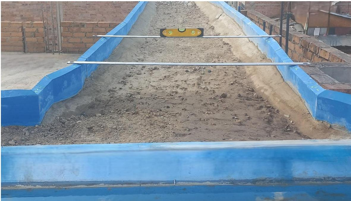
**Figura 62:** *Medición de la profundidad de los sedimentos*
