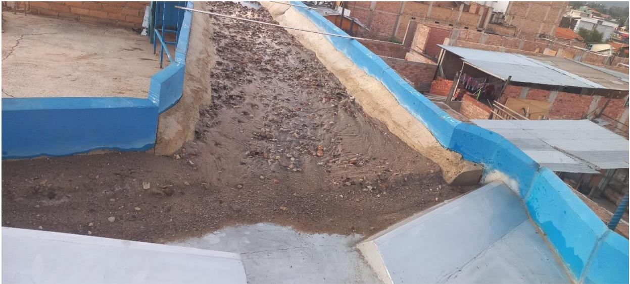
**Figura 70:** *Arrastre de sedimentos durante el ensayo con un caudal de  $6.081\text{m}^3/\text{s}$*
