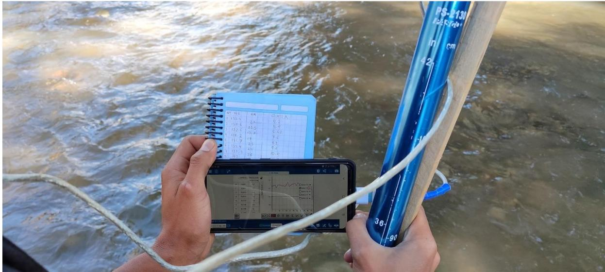
**Figura 44:** Medición de tirantes sobre la corona del barrage
