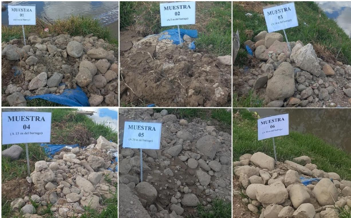
**Figura 51:** *Selección de sedimentos representativos (mezclado y cuarteo)*
