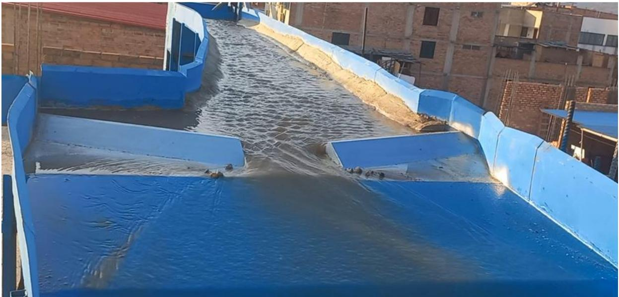
**Figura 71:** Arrastre de sedimentos durante el ensayo con un caudal de  $11.336 \text{ m}^3/\text{s}$
