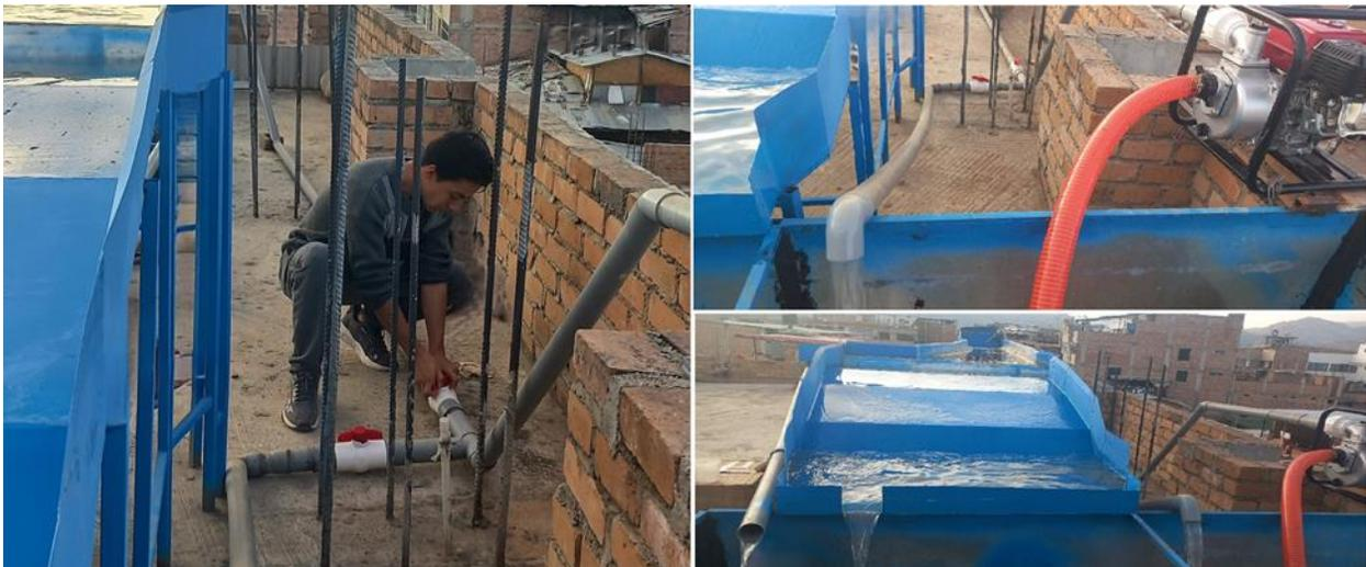
**Figura 67:** *Apertura del 20% de la parte central del barrage original*
