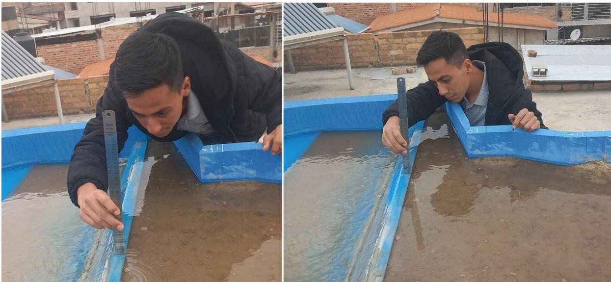
**Figura 64:** *Medición de caudales en proceso de calibración*
