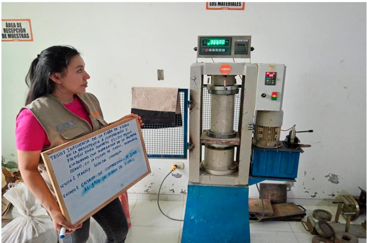
**Figura 21** Rotura de probetas a los 14 días concreto con 2% de fibra de vidrio
