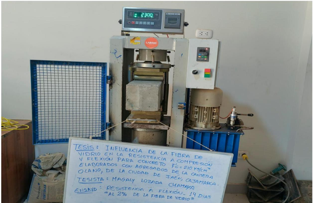
**Figura 33** Rotura de vigas 2% de fibra de vidrio 28 dias
