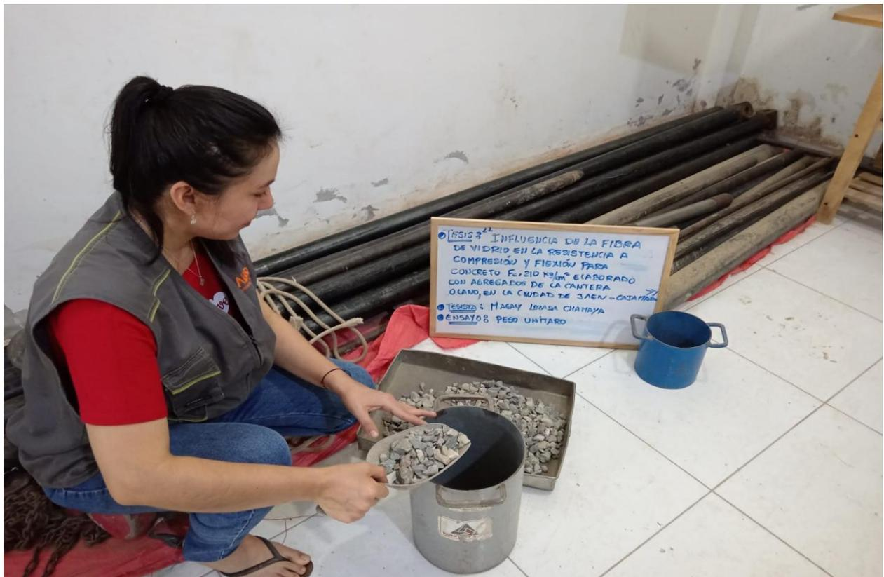
**Figura 7** Ensayo de peso específico y absorción del agregado grueso y fino
