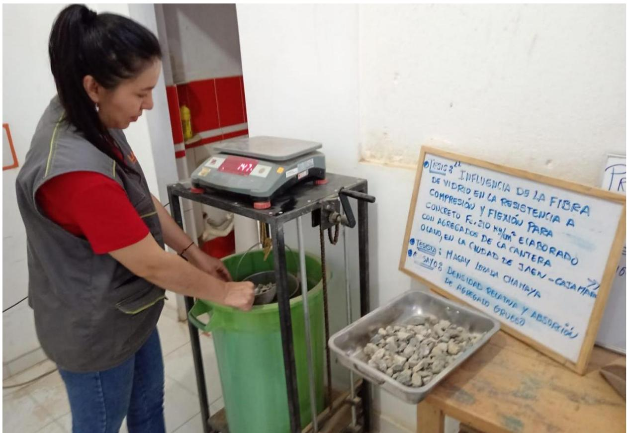
**Figura 8** Pesado de agregado fino para mezcla
