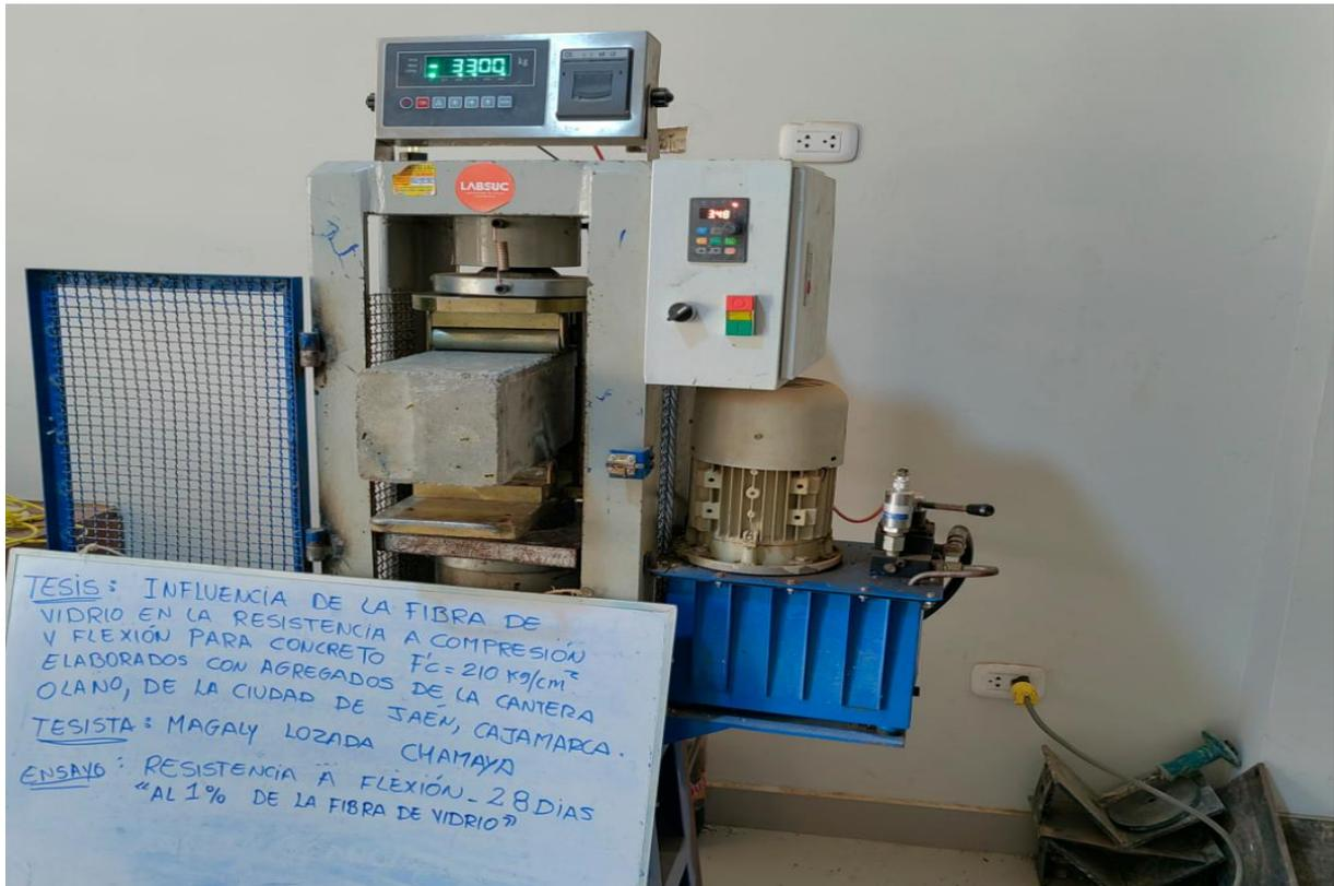
**Figura 31** Rotura de vigas 2% de fibra de vidrio 7 dias
