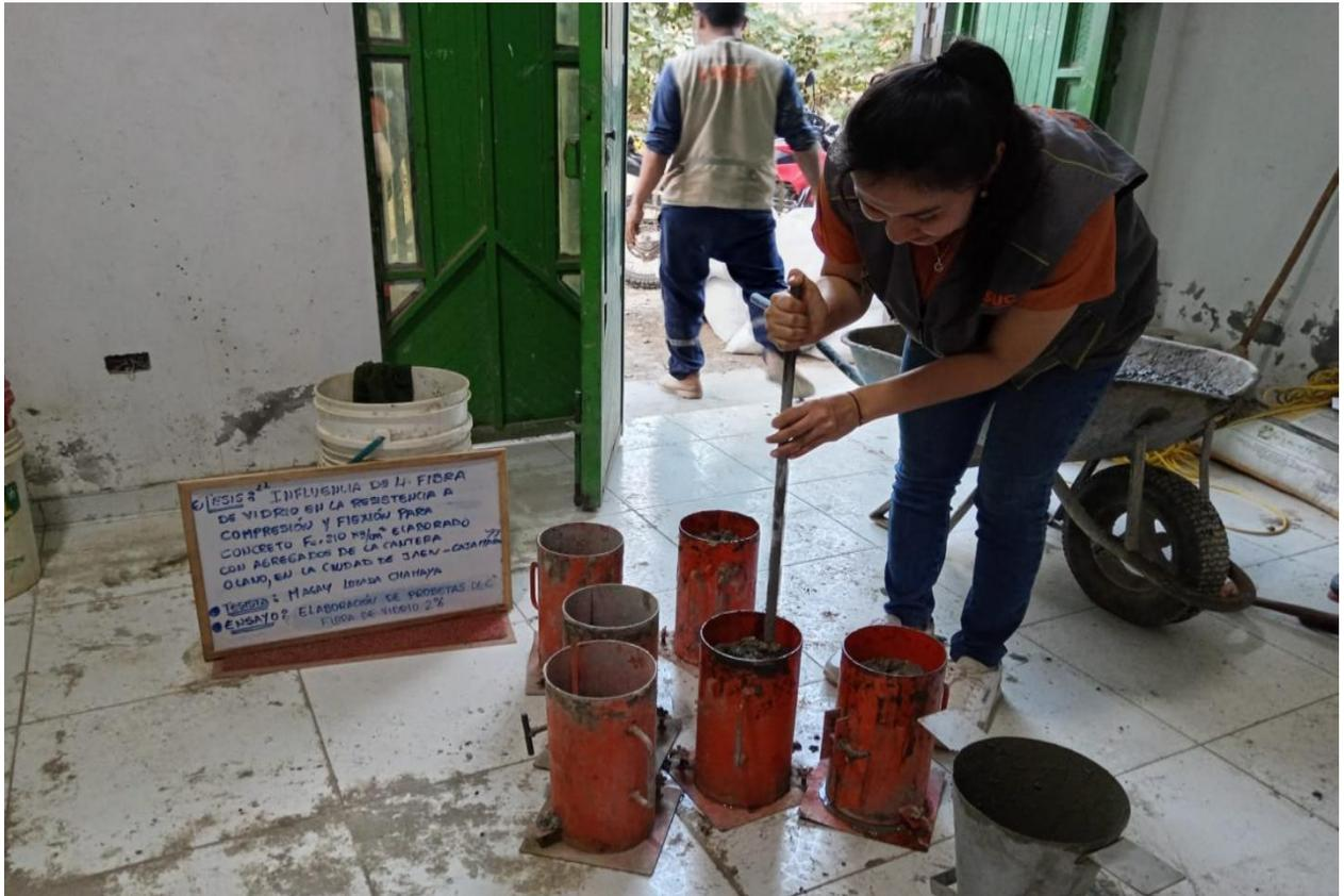
**Figura 15** *Probetas de concreto*
