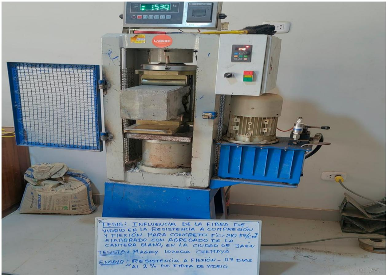
**Figura 32** Rotura de vigas 2% de fibra de vidrio 14 dias
