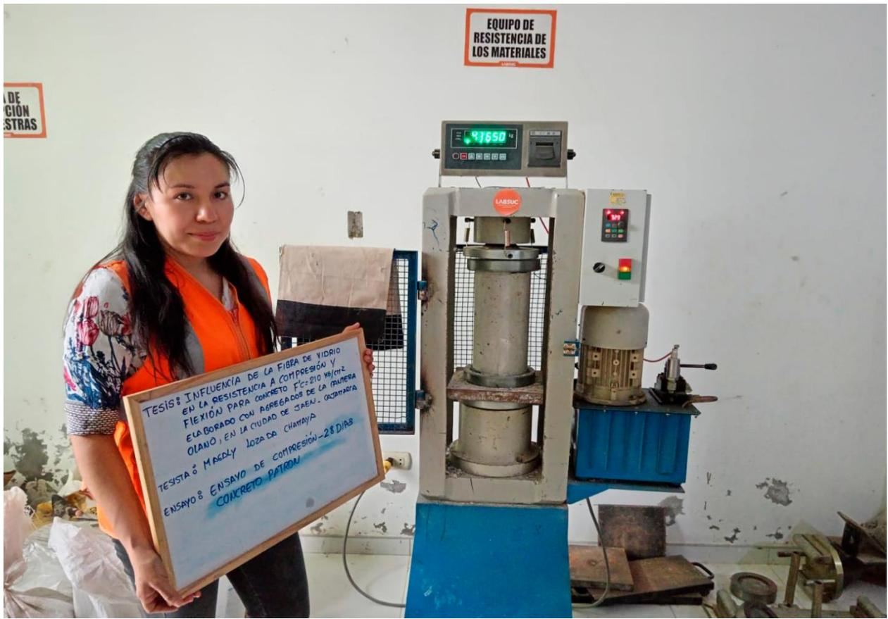
**Figura 23** Rotura de probetas a los 28 días on 1% de fibra de vidrio
