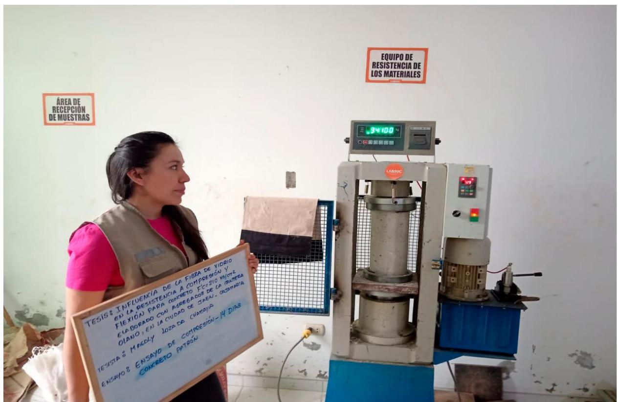
**Figura 20** Rotura de probetas a los 14 días concreto con 1% de fibra de vidrio
