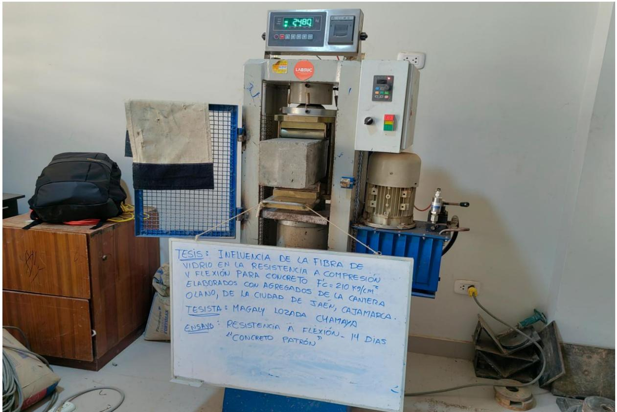
**Figura 27** Rotura de vigas patron 28 dias
