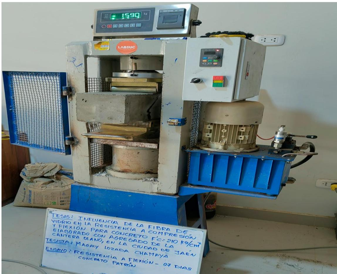
**Figura 26** Rotura de vigas patron 14 dias
