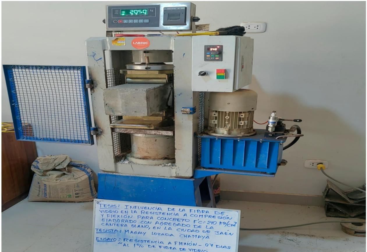
**Figura 29 Rotura de vigas 1% de fibra de vidrio 14 dias**
