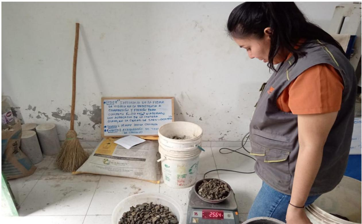
**Figura 10** Preparación de fibra de vidrio tipo E
