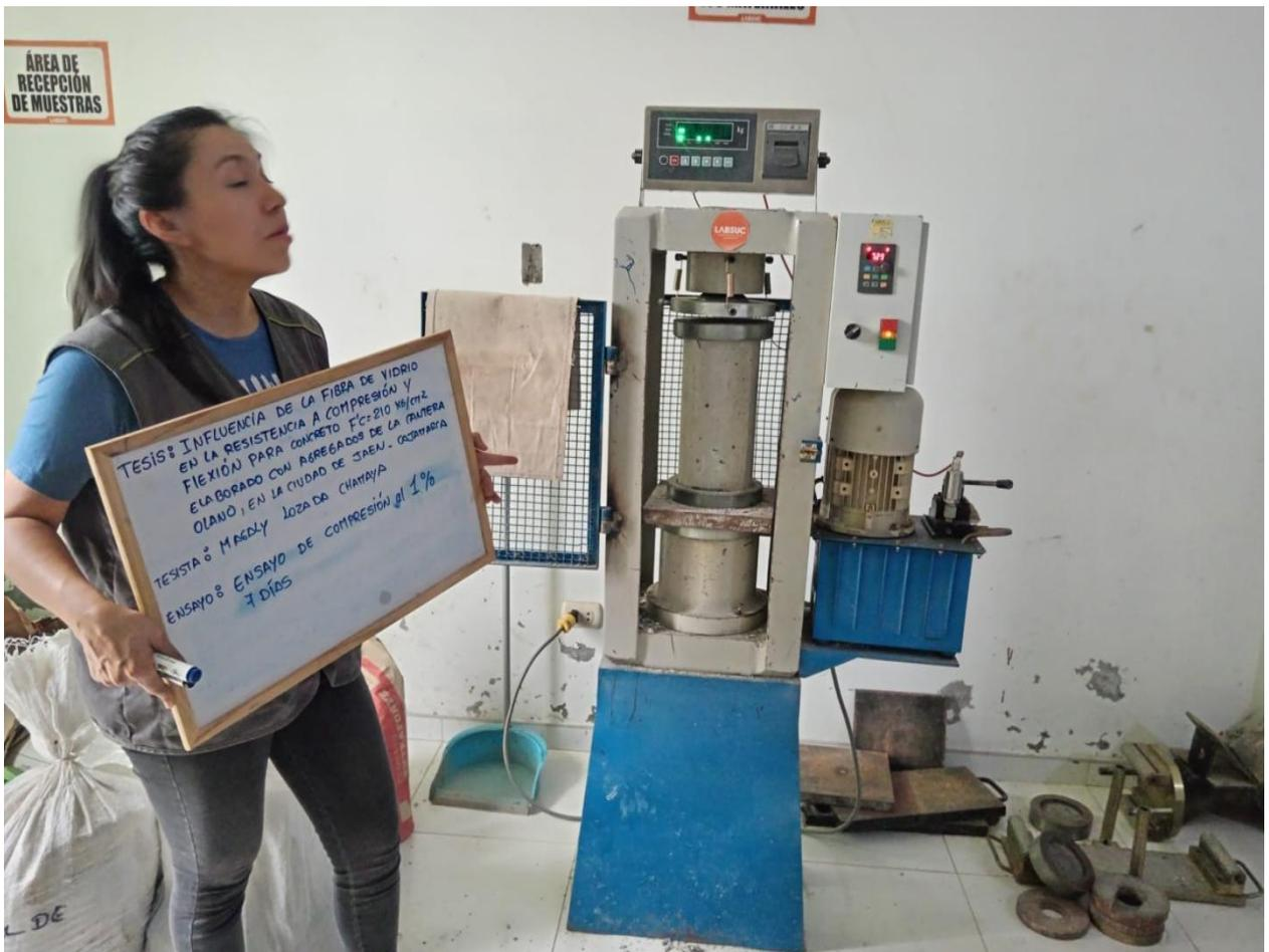
**Figura 18** Rotura de probetas a los 7 días 2% de fibra de vidrio
