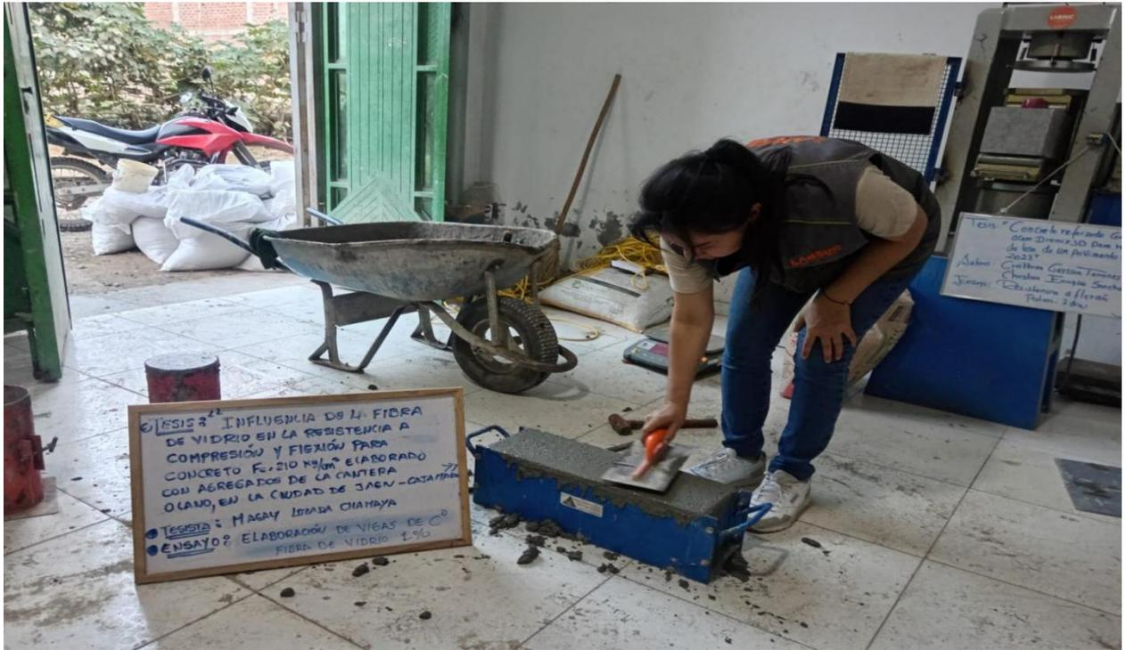
Figura 17 Rotura de probetas a los 7 días 1% de fibra de vidrio
