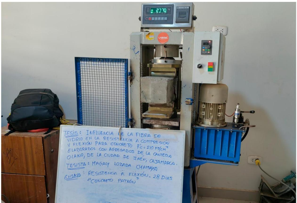
**Figura 28** Rotura de vigas 1% de fibra de vidrio 7 dias
