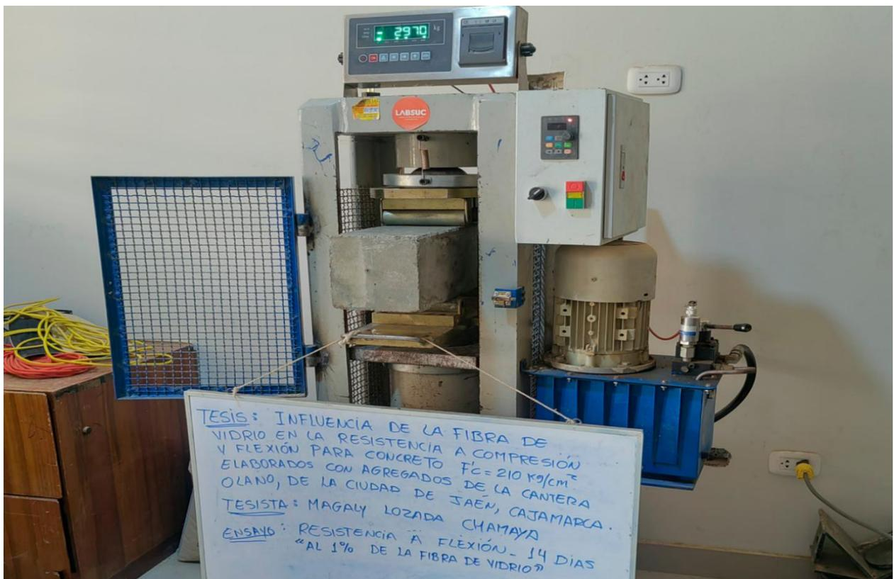
**Figura 30 Rotura de vigas 1% de fibra de vidrio 28 dias**
