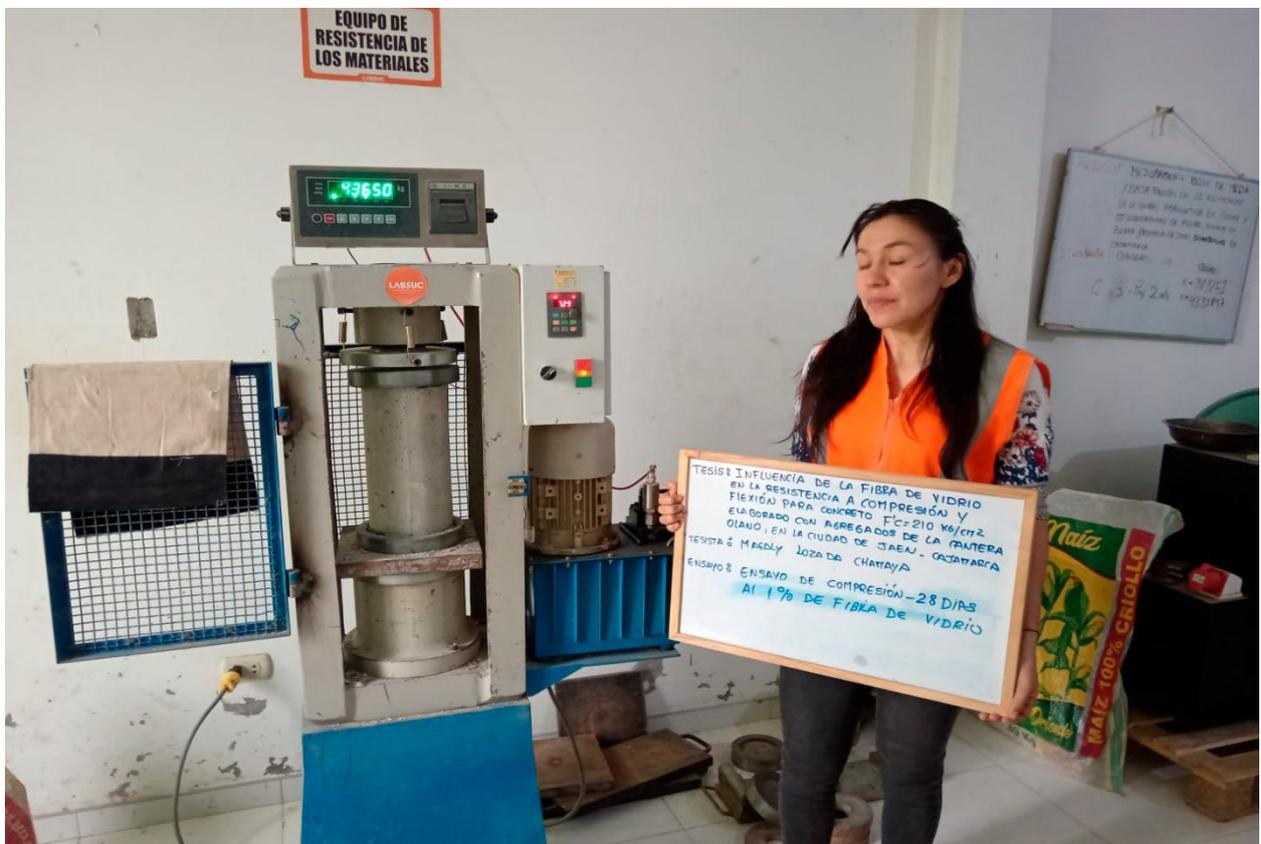
**Figura 24** Rotura de probetas a los 28 días con 2% de fibra de vidrio
