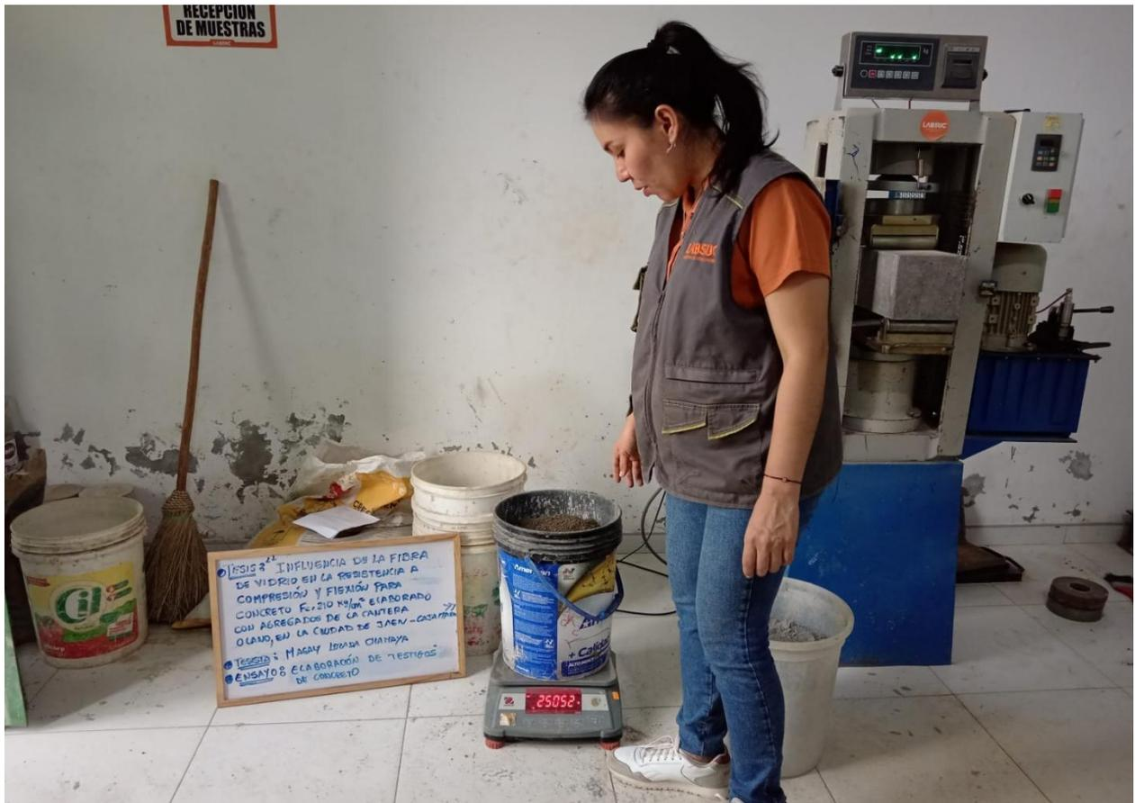
**Figura 9** Pesado de agregado grueso para mezcla
