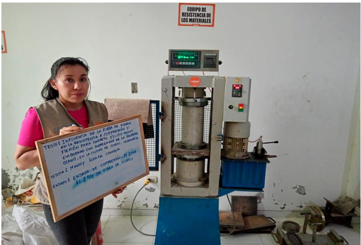
**Figura 22** Rotura de probetas patrón a los 28 días
