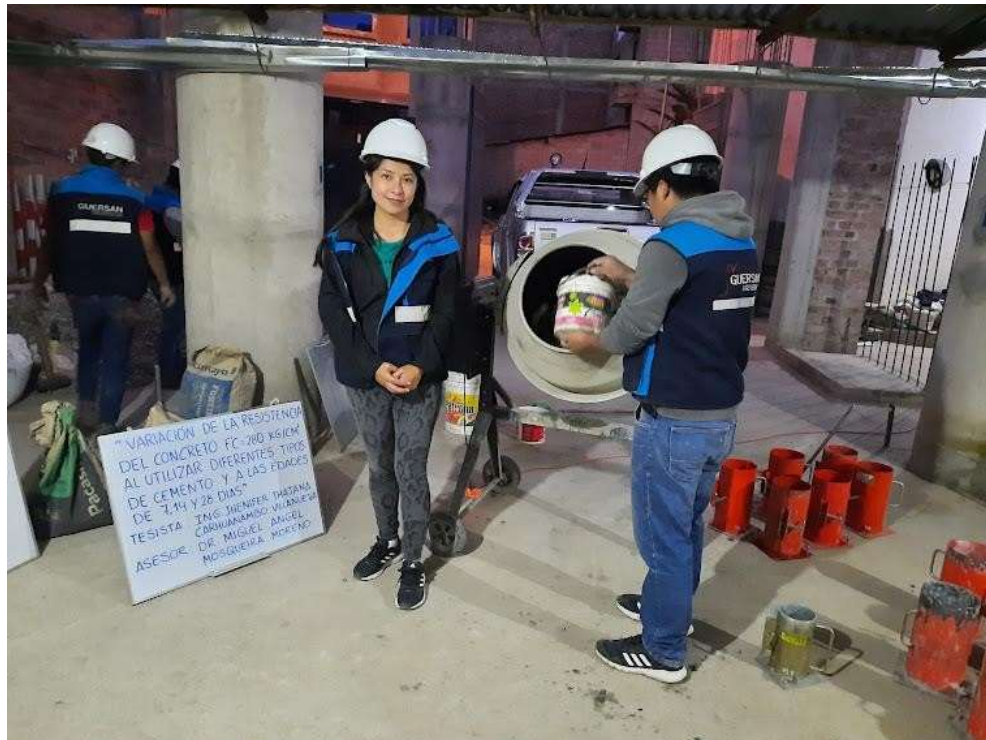
Figura 70. Elaboración de especímenes de concreto con cemento Tipo I y Tipo MS
