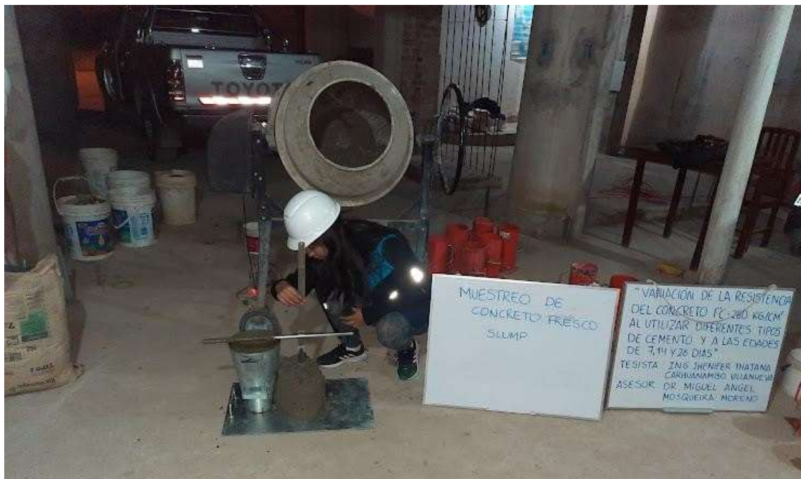
Figura 71. Prueba del Slump
