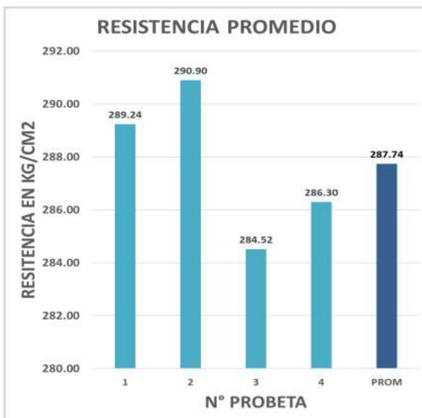
Figura 26. Resistencia Promedio del Concreto con Cemento Portland Tipo I a la edad de 14 días
