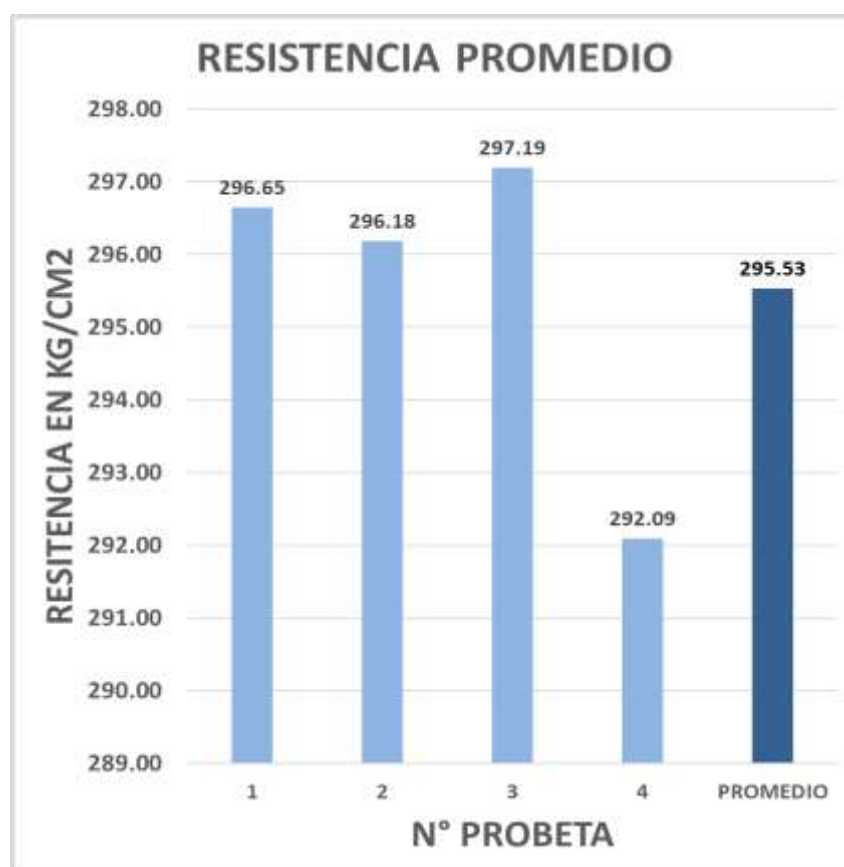
Figura 46. Resistencia Promedio del Concreto con Cemento Tipo ICo – Extra Forte a la edad de 28 días
