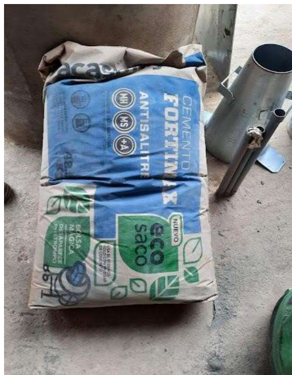
Figura 69. Cemento Tipo MS
