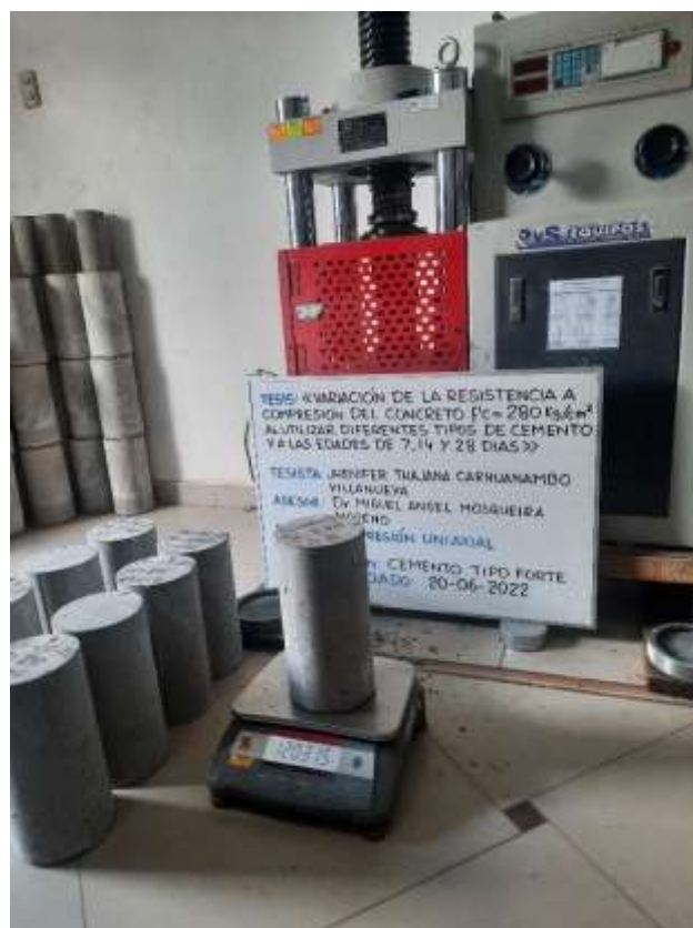
Figura 77. Probetas de concreto en la balanza, preliminar al ensayo de resistencia mecánica a compresión.
