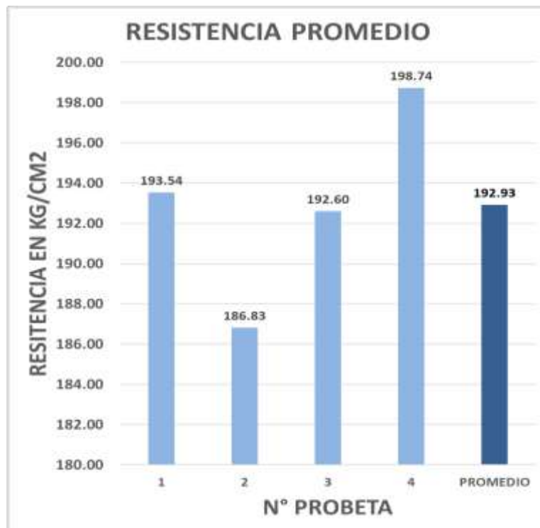
Figura 37. Porcentaje del f'c con Cemento Portland Tipo HS Nacional a la edad de 7 días
