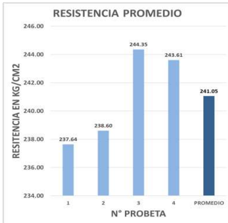
Figura 44. Resistencia Promedio del Concreto con Cemento Tipo ICo – Extra Forte a la edad de 14 días.
