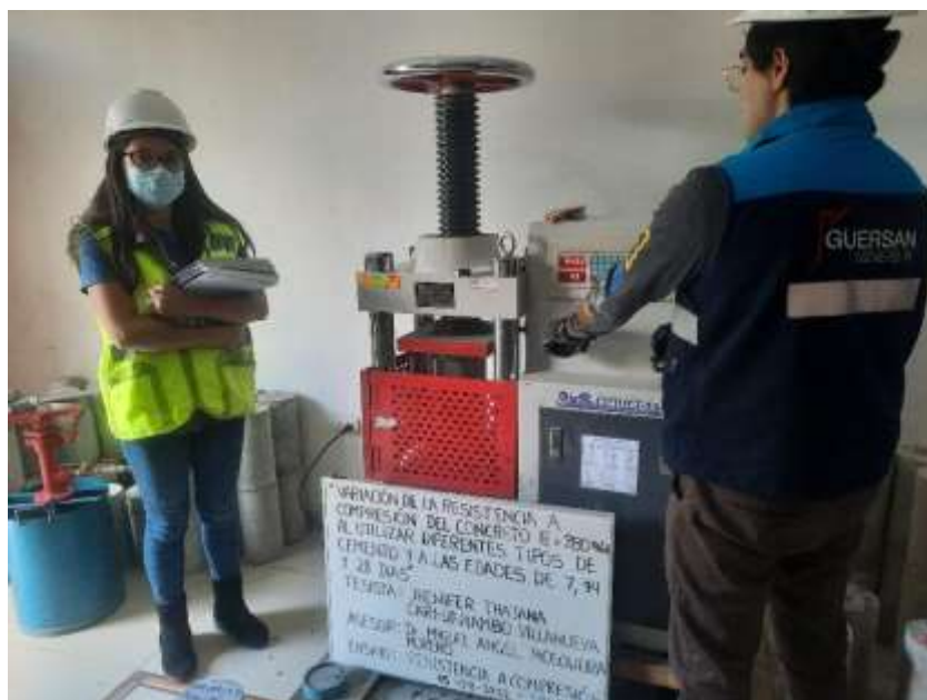
Figura 75. Ensayo de Resistencia a la Compresión con cemento Tipo V
