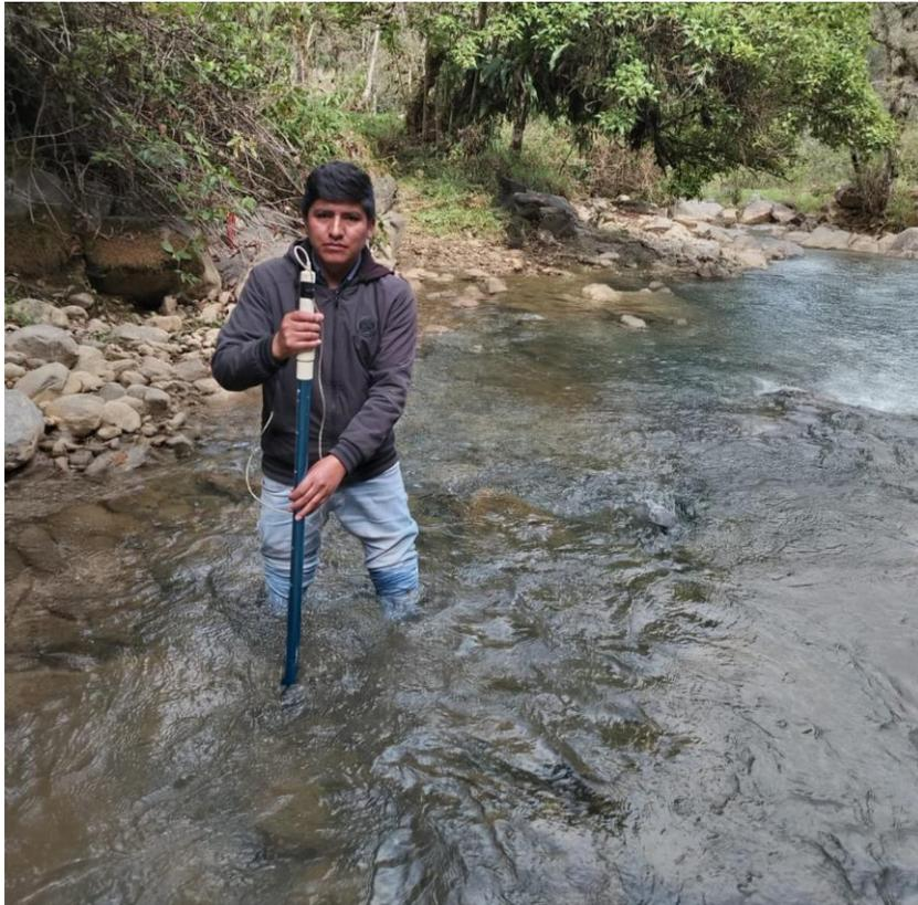
**Figura N° 20 Aforo con el equipo correntómetro en el punto de medición E-06**
