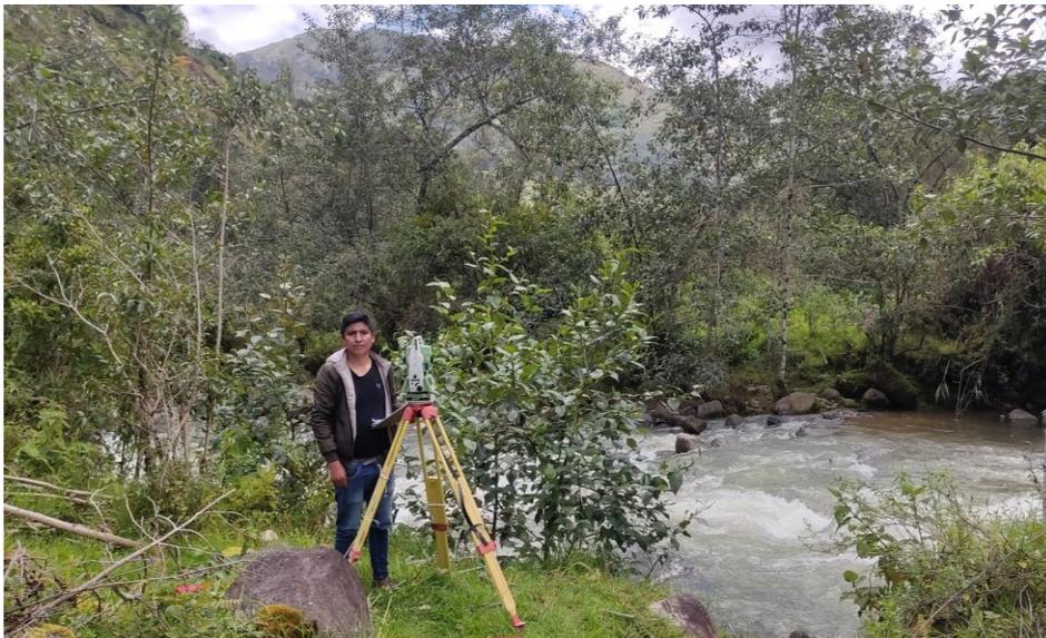
**Figura N° 13 Levantamiento topográfico de los puntos de aforo dentro del caseríos Amarcucho y Sendamal (Parte media del río Sendamal)**
