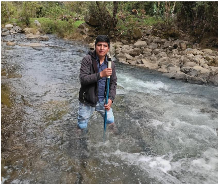
**Figura N° 21 Aforo con el equipo correntómetro en el punto de medición E-07**
