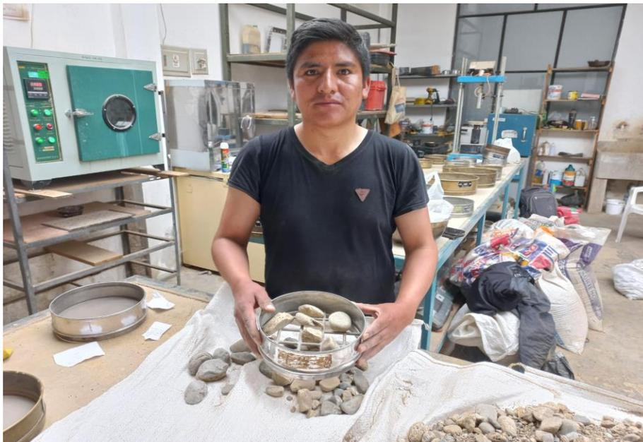
**Figura N° 33 Separación de los tamaños de las muestras de suelos, de acuerdo al tamizado**
