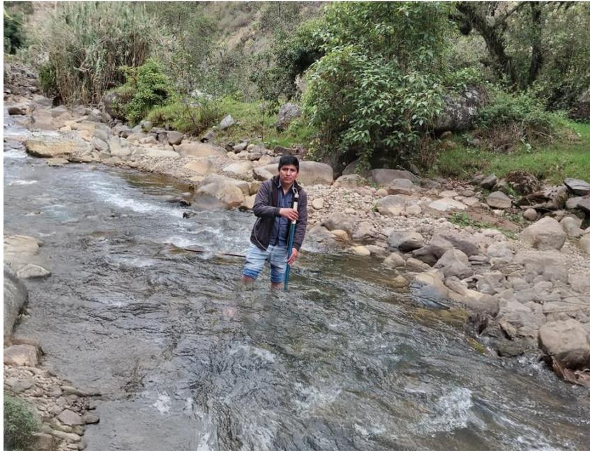
**Figura N° 18 Aforo con el equipo correntómetro en el punto de medición E-04**
