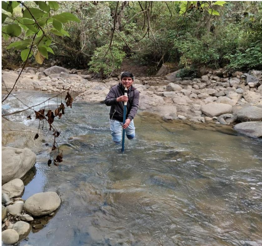
**Figura N° 19 Aforo con el equipo correntómetro en el punto de medición E-05**
