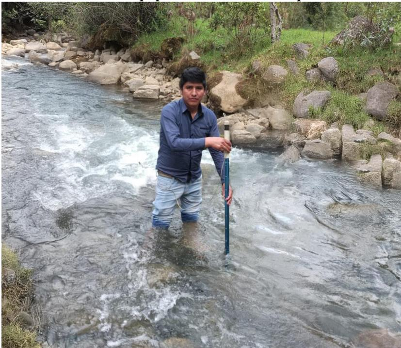
**Figura N° 17 Aforo con el equipo correntómetro en el punto de medición E-03**
