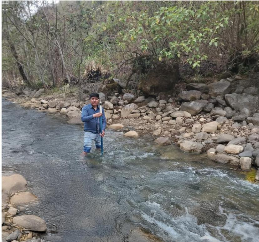
**Figura N° 16 Aforo con el equipo correntómetro en el punto de medición E-02**
