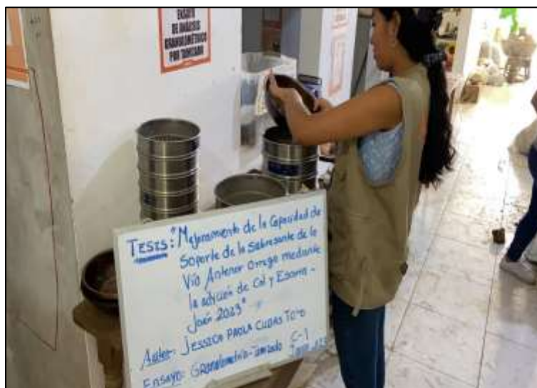
Fotografía 02: Análisis granulométrico por tamizado
