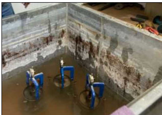
Fotografía 06: Moldes de la muestra de CBR sumergidos en agua
