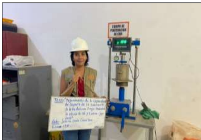
Fotografía 05: Realización del ensayo de penetración del CBR patrón
