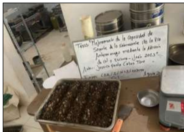
Fotografía 07: Se mezcla la muestra con las adiciones de cal y escoria de cobre para el CBR.
