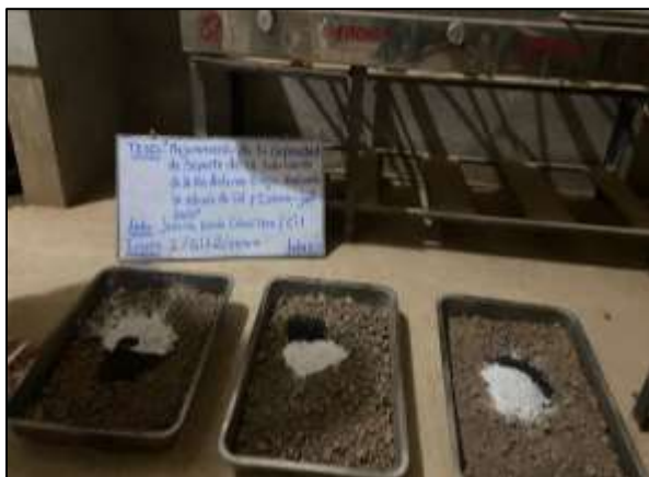
Fotografía 07: Se mezcla la muestra con las adiciones de cal y escoria de cobre para el CBR.
