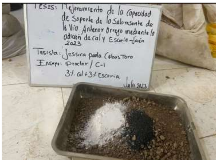
Fotografía 08: Realización del ensayo de Proctor con la cal y escoria de cobre.
