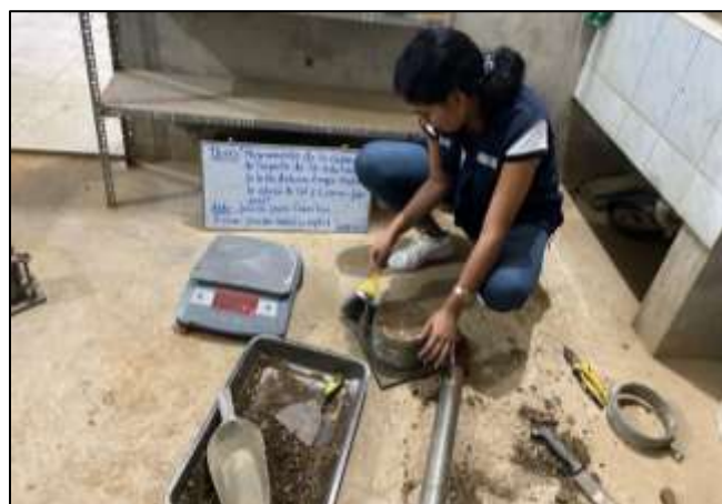
Fotografía 04: Realización del ensayo de Proctor de la C-1
