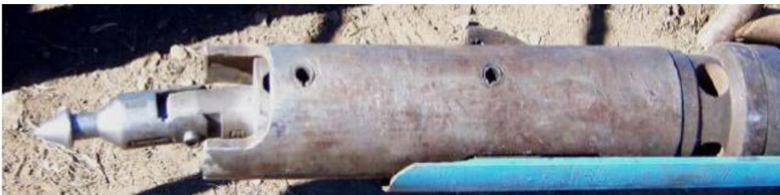
Figura 14. Parte superior del cabeza al que va enroscado el tubo saca testigos (tubo interior).
