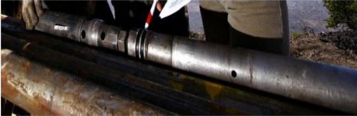
Figura 13. Cabezal y tubo interior o saca testigos.
