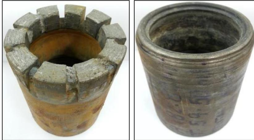
Figura 05. Broca con canales de refrigeración obstaculizados (izquierda) y broca fundida (derecha).
