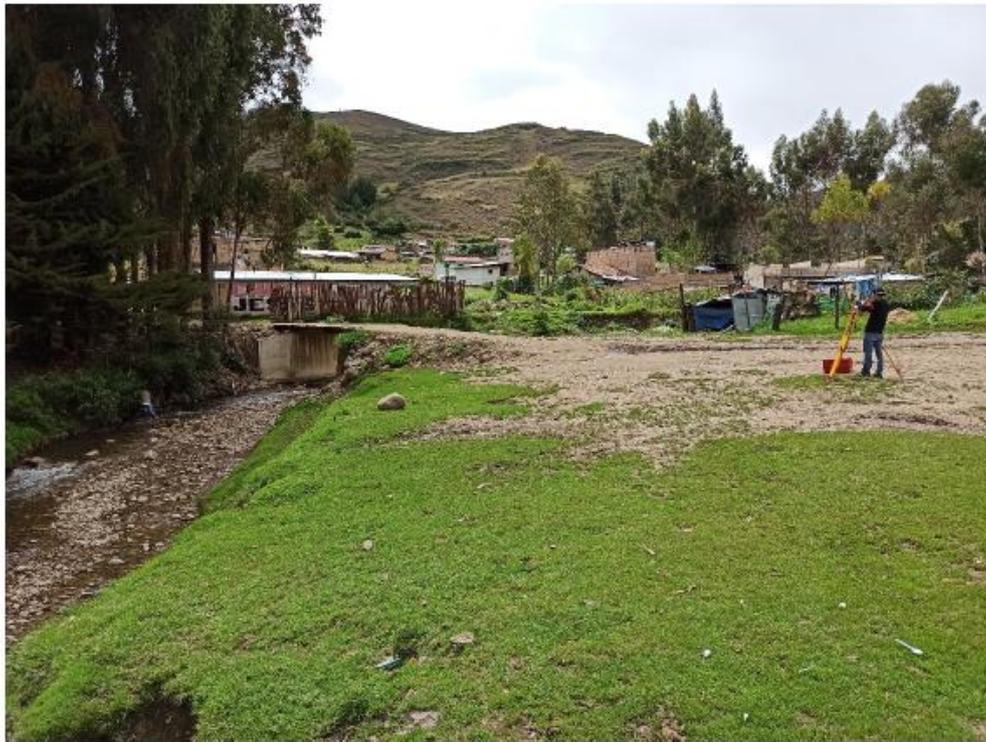
*Figura 56. Levantamiento Topográfico con Estación Total.*
