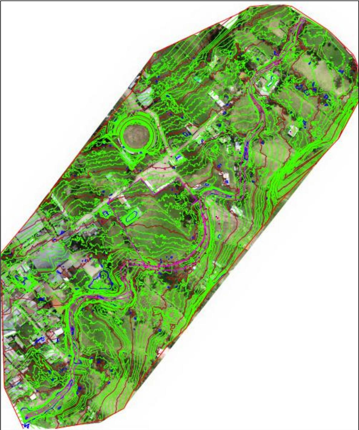
*Figura 15. Levantamiento topográfico con ensamblaje de puntos del río.*
