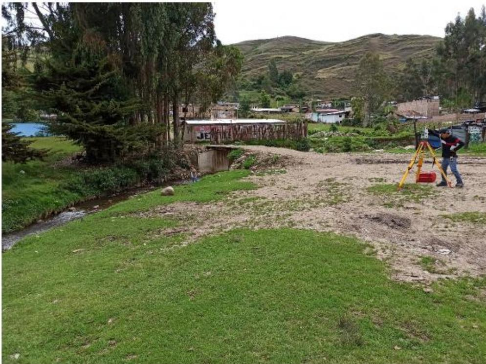
*Figura 59. Levantamiento Topográfico con Estación Total.*
