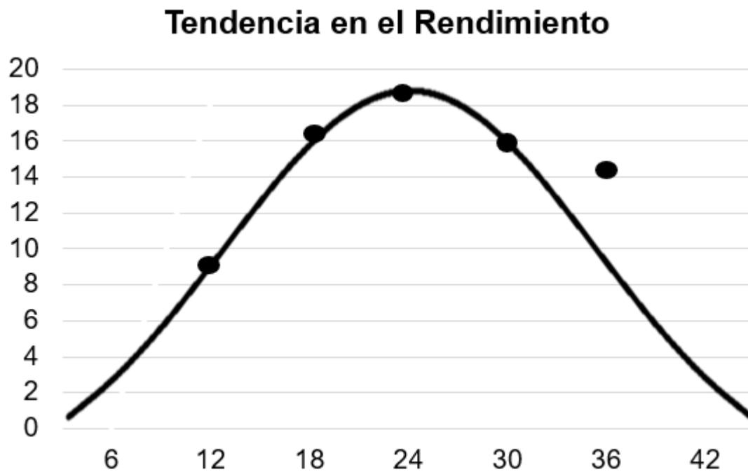
La figura 7 expresa la importancia de la aplicación de láminas de riego de manera controlada, indicando que sin agua no habrá producción y un exceso de agua también anula la producción, entonces es fundamental conocer el punto óptimo de requerimiento hídrico del cultivo.
