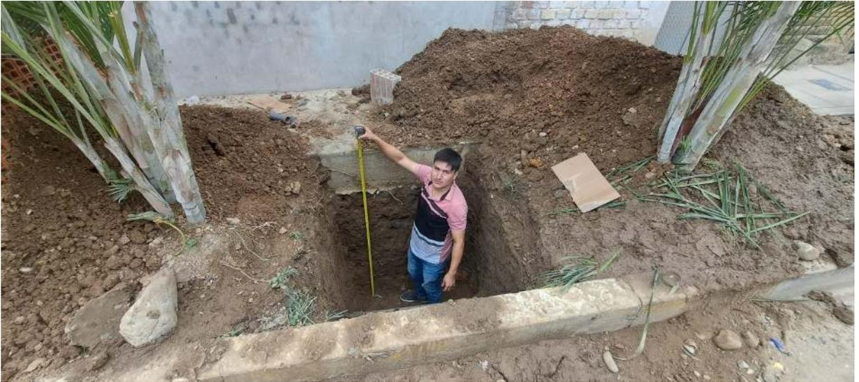
**Figura 115 Realización de ensayo de contenido de humedad y Límites**
