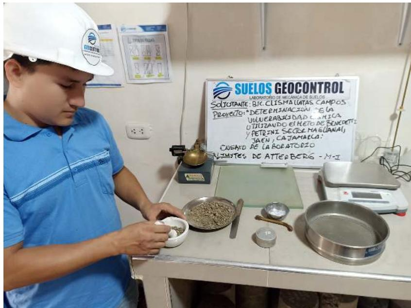
**Figura 116 Colocado de muestra al horno electrónico para obtener el contenido de humedad**
