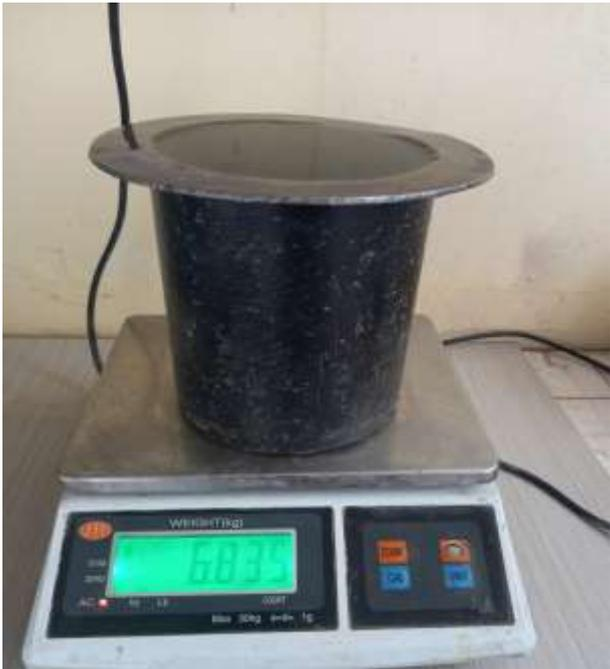
Figura 16. Ensayo de peso unitario compactado, agregado fino.
