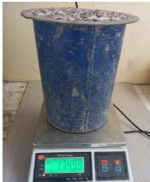
Figura 14. Peso de fiola con muestra y agua hasta menisco, ensayo de peso específico.
