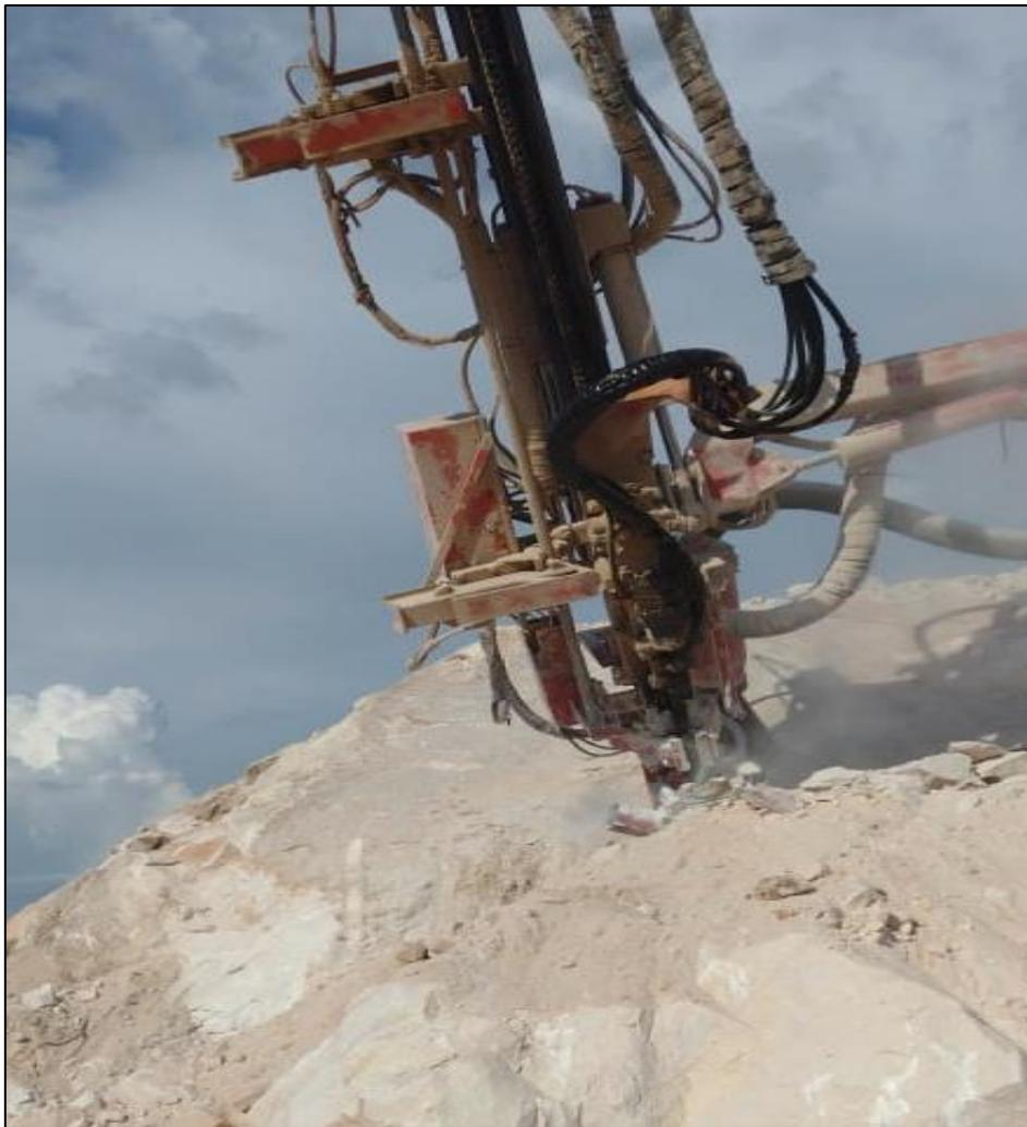
Figura 1: Perforación en roca dura tipo arenisca.
