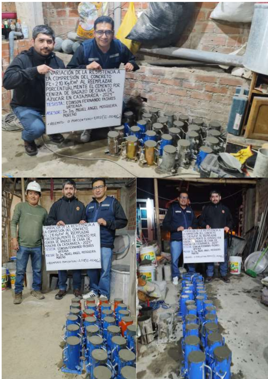
Figura 23 Elaboración de especímenes de concreto
