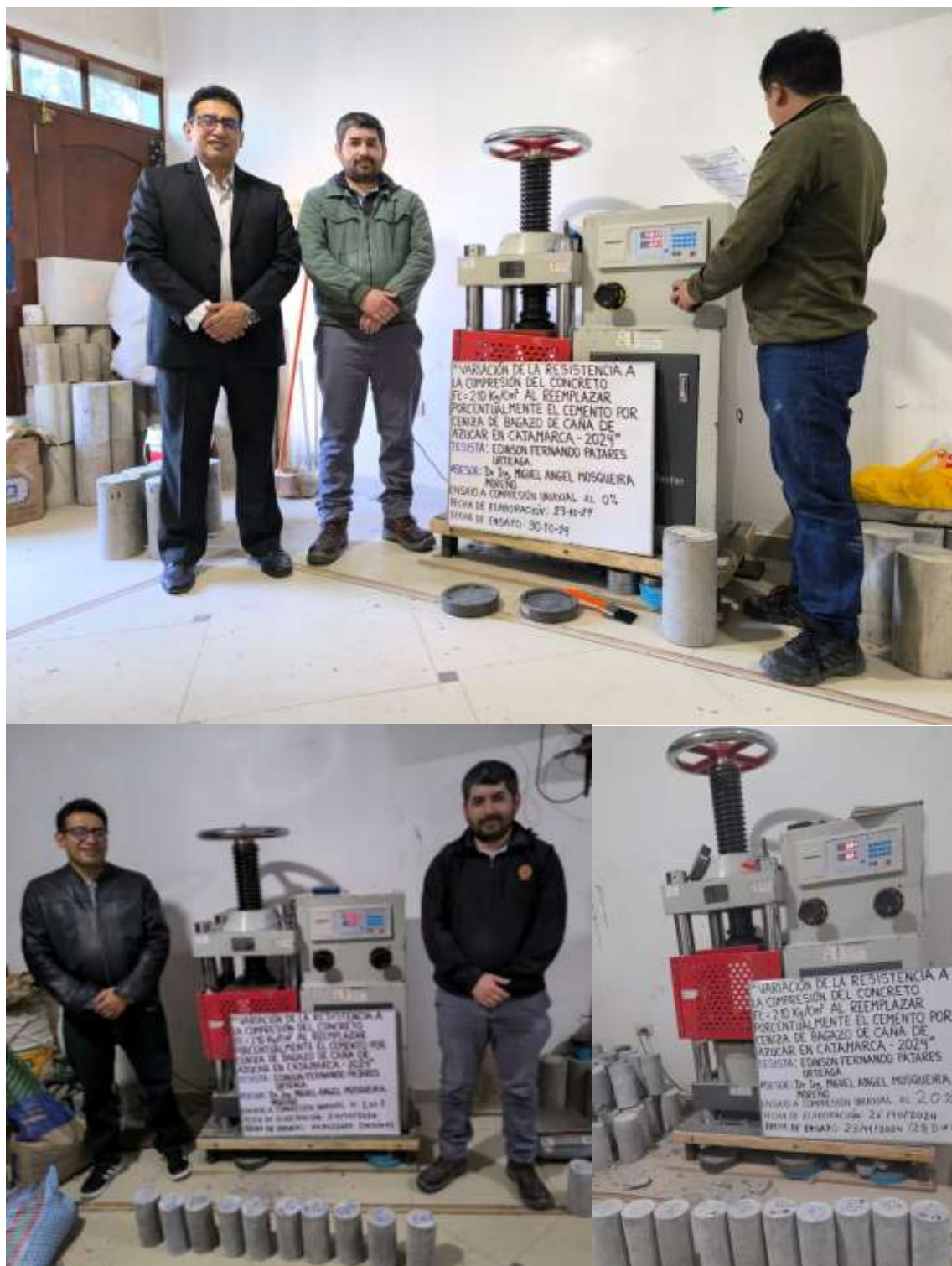
Figura 24 Ensayo a compresión de los especímenes de concreto
