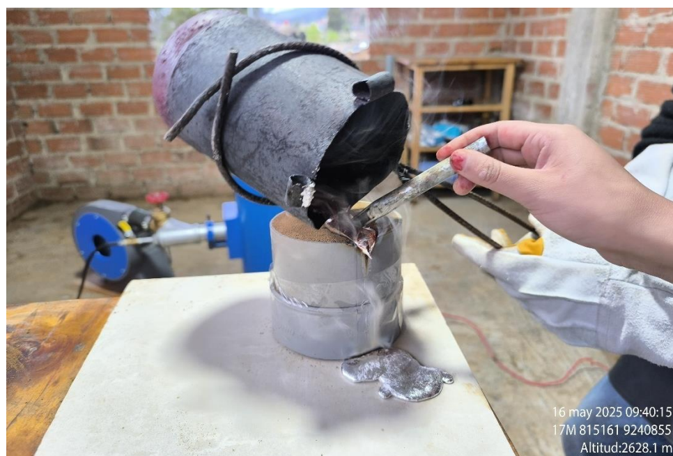
Figura 20 Vertido de metal fundido en molde de arena.
