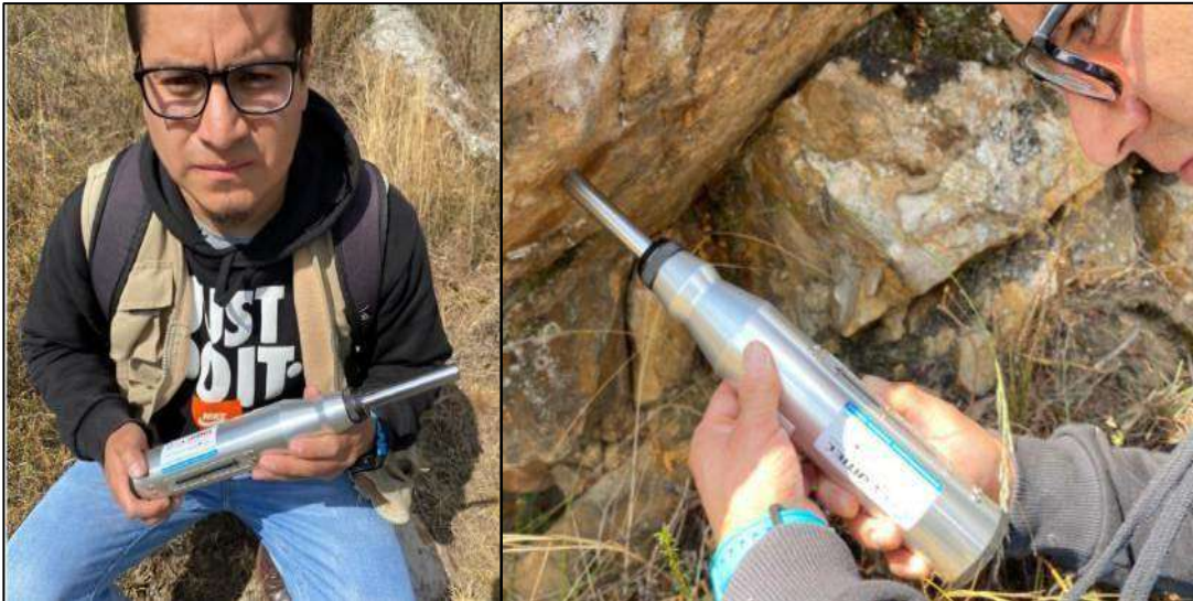
Figura 36. Martillo de Schmidt CONTROLS, tipo L, Modelo 45- 561.
