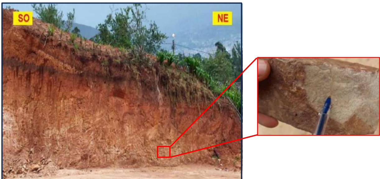
Figura 16. Areniscas gris marrones de la Formación Carhuaz - Foto tomada al NO del Centro Poblado de Huacapampa.
