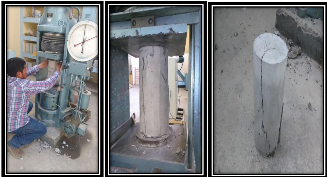
Imagen N° 14: Rotura de probetas patrón de diseño.
