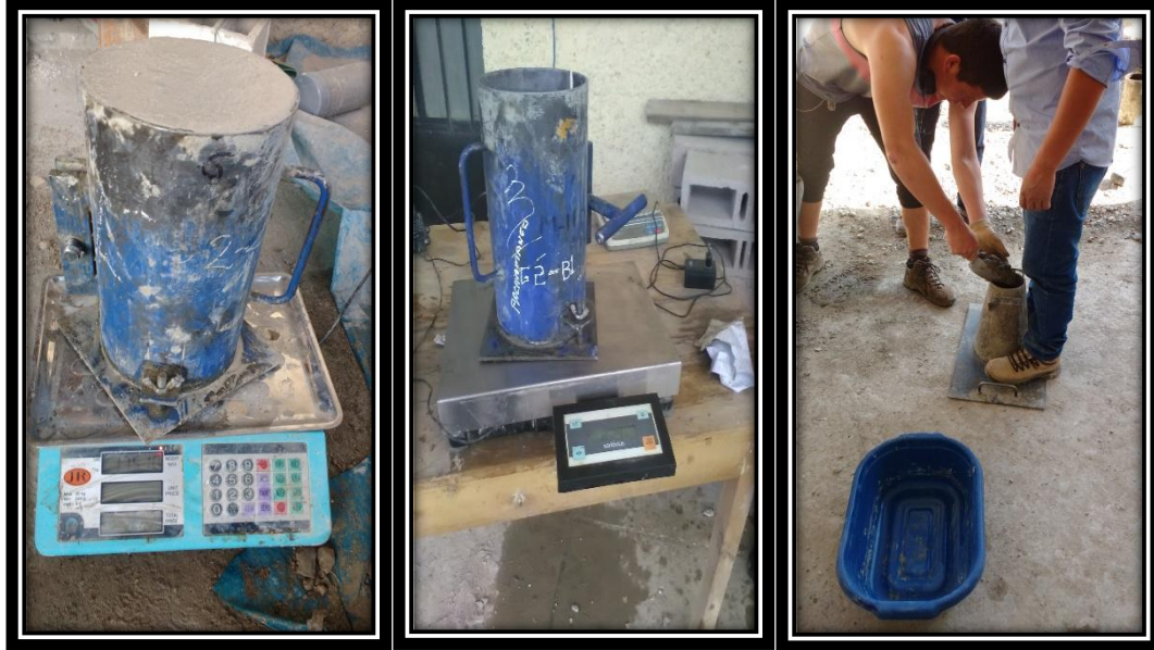
Imagen N° 13: Ensayo de slump y peso unitario de concreto fresco.
