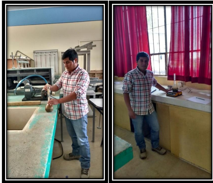
Imagen N° 7: Ensayo del peso específico del agregado.
