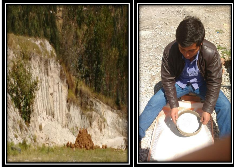
Imagen N° 11: Ensayo de gravedad específica de la puzolana-traquita.
