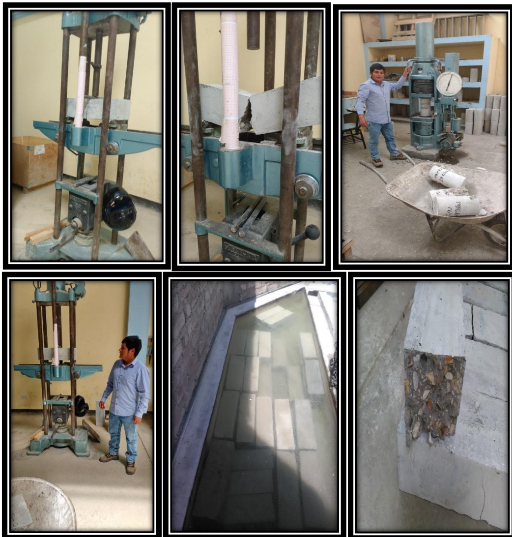
Imagen N° 18: Ensayo a la flexión.
