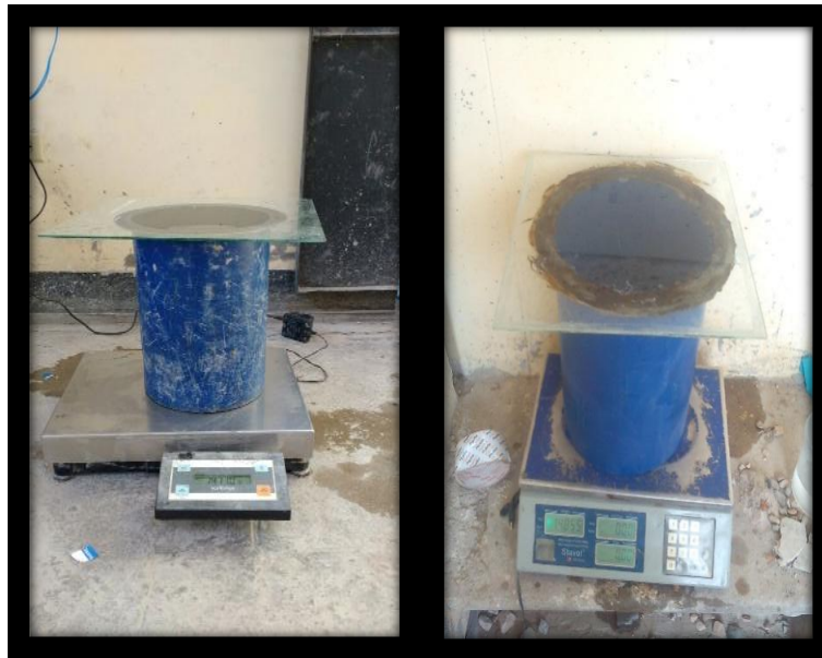
Imagen N° 5: Determinación del volumen del recipiente para ensayos de peso unitario del agregado y del concreto
