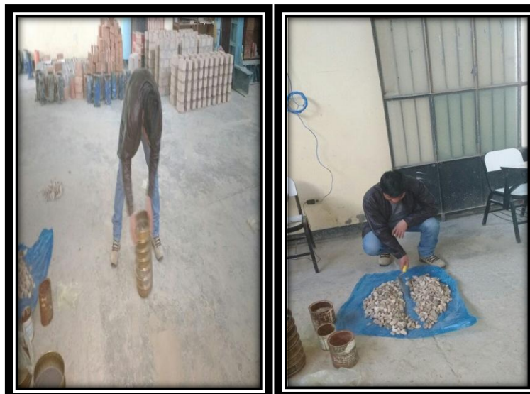
Imagen N° 8: Ensayo completo de granulometría del agregado.
