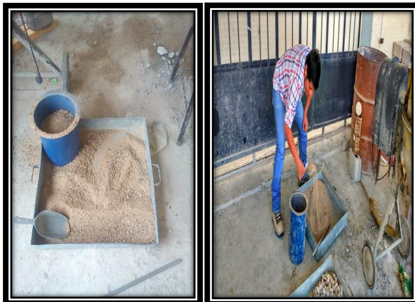
Imagen N° 6: Ensayo completo de peso unitario del agregado
