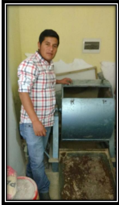
Imagen N° 9: Ensayo completo de abrasión del Agregado.
