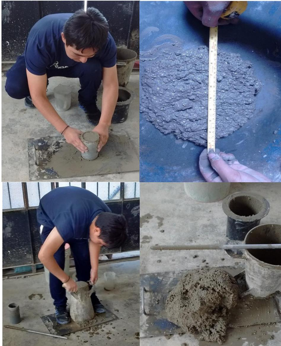
*Fotos de arriba:* Ensayo de fluidez ASTM D 6103
