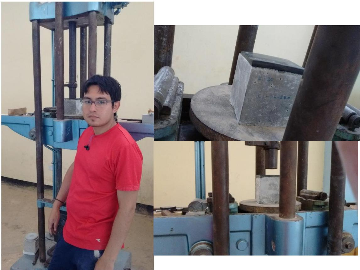
Figura n° 56: Ensayo de compresión en bloques de Concreto Ligero
